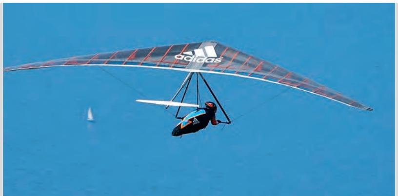
Aeros war der einzige Drachenhersteller auf der Thermik. Zu sehen war der Combat C aus Vollcarbon. Dieser Drachen ist der einzige turmlose Hochleister auf dem Markt, der sehr einfach auf 3,5 Meter kurzgepackt werden kann. Die kleinste Größe (12.4) wiegt 30.5 kg. Der neue Gurt Viper C hat nun das DHV-Gütesiegel.
