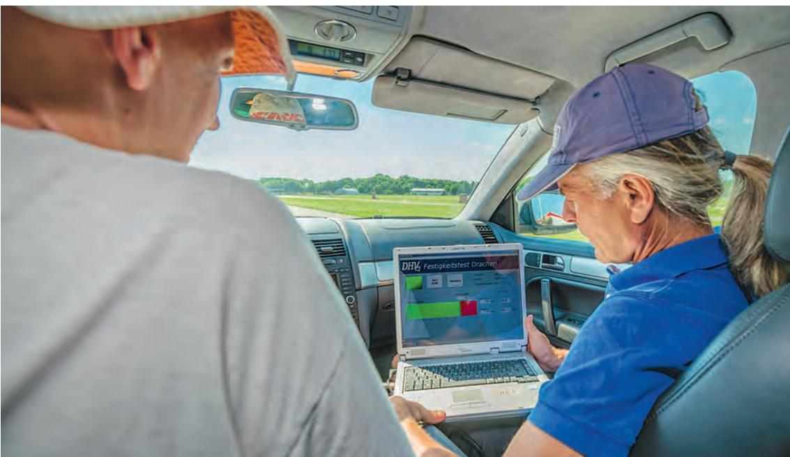
← Während der Testfahrt werden die Messwerte vom Belastungsanhänger auf einen Laptop im Zugfahrzeug übermittelt. Sobald die geforderten Mindestwerte erreicht sind, wird die Fahrt beendet.
