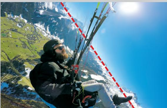
Aufwinde oder Steigzentren können den Schirm auch in der Kurve aufstellen. Dies erhöht den Anstellwinkel. Das Nachzentrieren sollte NICHT durch Weiterziehen oder Halten der Steuerleine (wie im Bild sichtbar), sondern durch Lösen und Nachziehen erfolgen.
