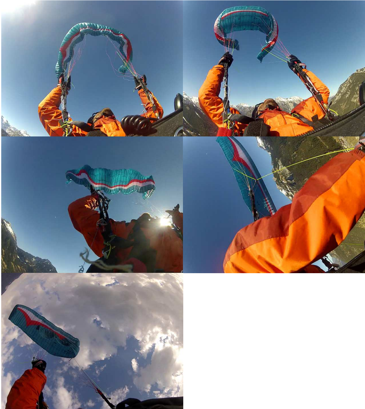
Gin Carrera S: Frontklapper mittlerer Größe (oben links) öffnen meist mit stark eingeklappten Flügelenden, aber sonst selbständig (oben rechts). Sehr große Frontklapper (Mitte links) können extreme Dynamik generieren, z.B. so starkes Vorschießen, dass der Testpilot den gesamten Steuerweg zum Abfangen benötigt (Mitte rechts). Häufig auch ein- oder beidseitige Verhänger der Außenflügel, was einen sofortigen Piloteneingriff erfordert (unten links).
