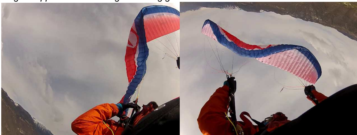
Swing Discus M: Große, flächentiefe Einklapper können ein deutliches Vorschießen mit Gegenklapper ohne Richtungsänderung generieren.
