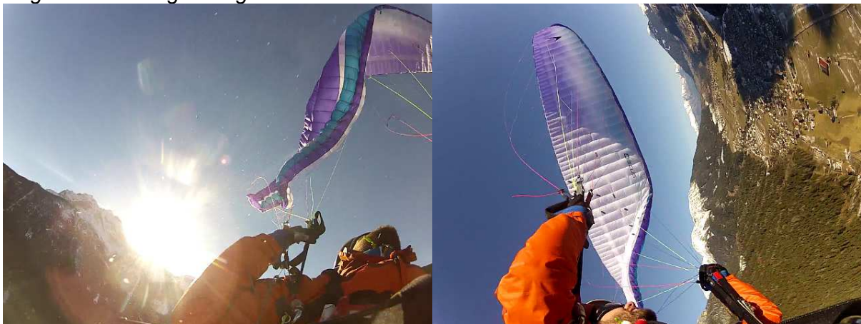
Swing Discus M: Große, flächentiefe Einklapper können ein deutliches Vorschießen mit Gegenklapper ohne Richtungsänderung generieren.
