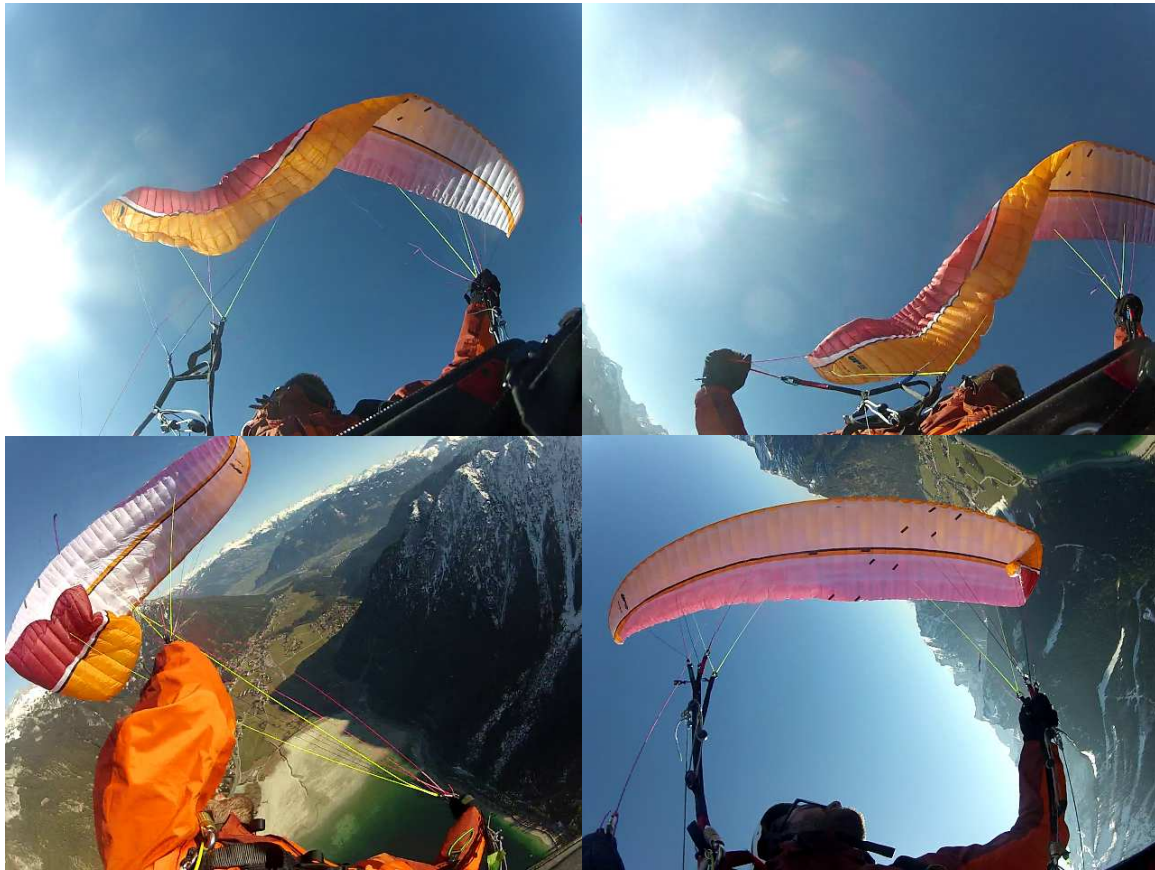
UP Kantega XC 2 M: Unbeschleunigt war es für die Testpiloten schwierig, Klapper im Messfeld zu erzielen (oben links). Die Reaktionen des Schirmes waren für die Klasse in Ordnung. Beschleunigt klappt der Schirm mit deutlich mehr Flächentiefe (oben rechts) und zeigt ein sehr anspruchsvolles Verhalten. Weites Vorschießen, massiver Gegenklapper (unten links) teils mit Verhängern (unten rechts).
