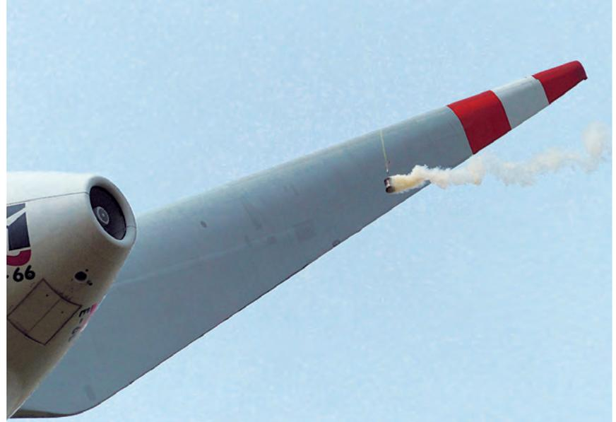
Die Rauchkörper wurden mit einer 10 m langen Leine an einem Multicopter befestigt und im Lee der Windkraftanlage platziert.
