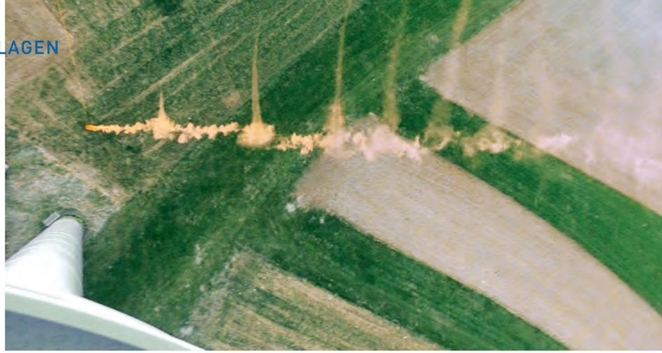
Blick vom Geschiebekopf des WKA nach unten mit dem positionierten Rauchkörper. Dahinter die abschwimmenden Wirbel.
