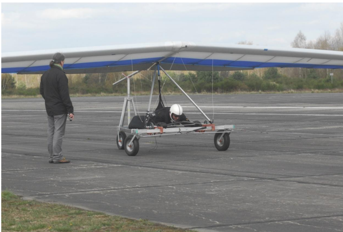
Foto 2: Der Anstellwinkel für Starrflügel wird genau wie auch beim Drachen nach der Pilotenposition gemäß Skizze eingestellt.
