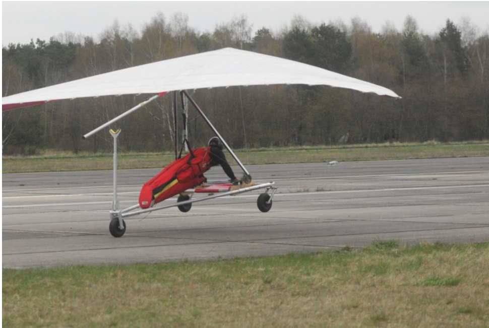
Foto 4: So sieht ein Start aus, wenn der Pilot das Festhalteseil zu lange hält. Der Startwagen hat mit den Vorderrädern bereits abgehoben!
