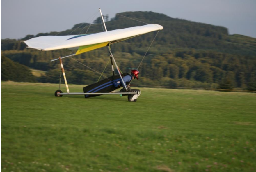
Foto 6: Falsche Pilotenhaltung, der Pilot lässt sich vom Seilzug nach vorne ziehen und erreicht so eine sehr hohe Abhebegeschwindigkeit! Dies führt häufig zum Kavalierstart und damit zum Übersteigen des Schleppflugzeugs.
