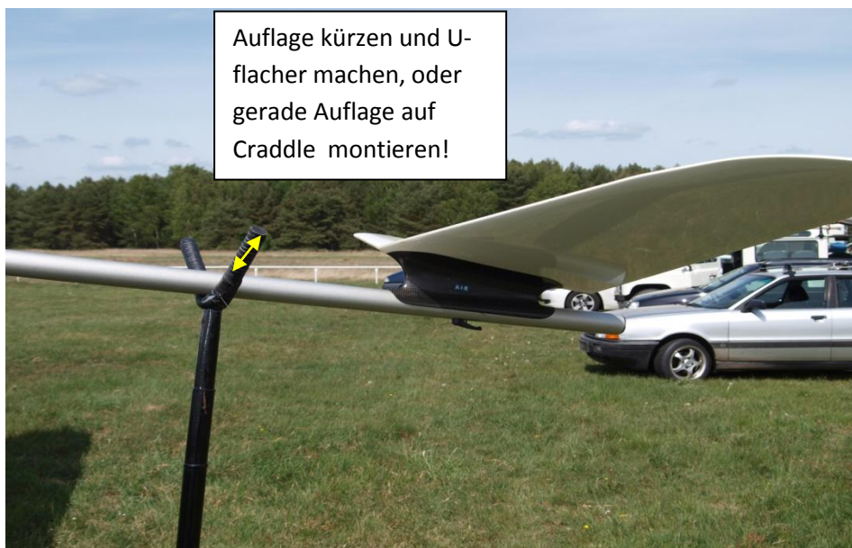
Foto 7 ...zu hohe Kielrohrauflage für Starre mit Leitwerk
