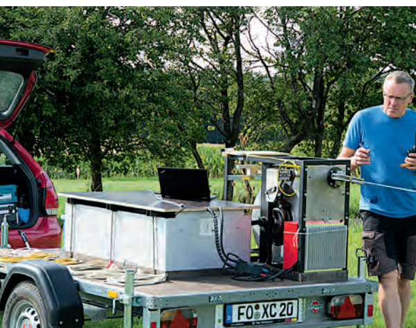
↑ Windenanhänger mit einem Windenmodul und Akku
