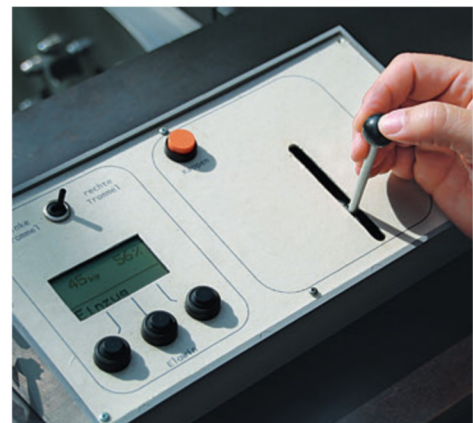
↑ Steuerpult mit Display und Steuerhebel
