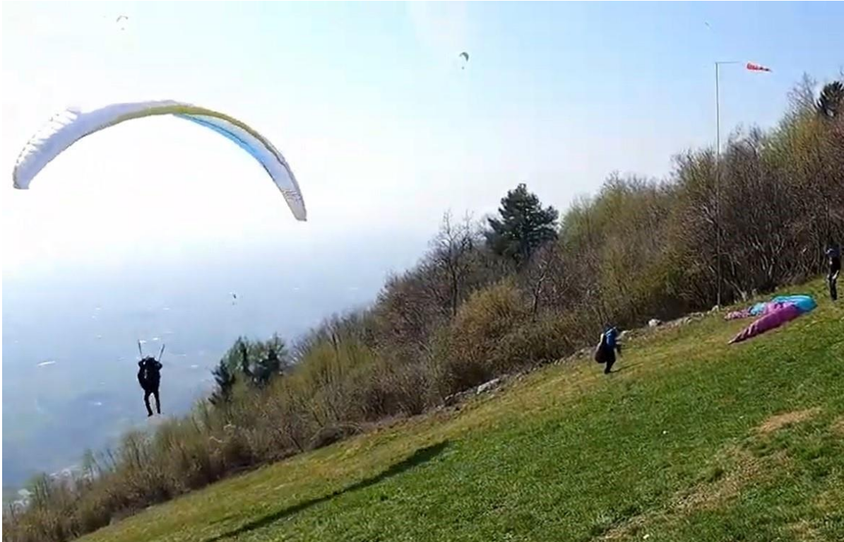
Abbildung: Bereits kurz nach dem Abheben rutscht der Pilot teilweise nach unten aus dem Gurtzeug
