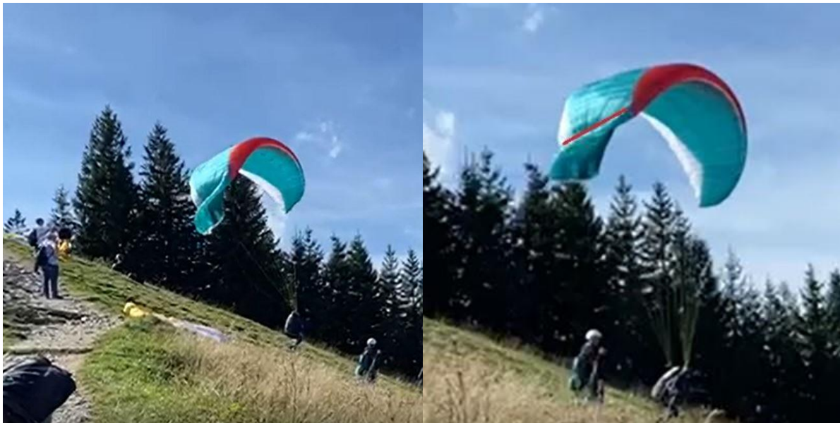
Abbildungen 1 und 2: Der Gleitschirm beim und nach dem Aufziehen. Der eingefügte rote Strich (rechtes Bild) verdeutlicht den Verlauf der übergeworfenen A-Leine.
