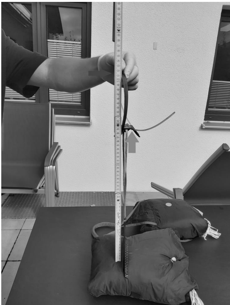
Bild 1 zeigt die Länge der Verbindung Griff-Innencontainer von 52 cm (waagrechter Pfeil) und das steife Gurtband, das im rechten Winkel zu den Splinten absteht (senkrechter Pfeil). Im Hintergrund ein Innencontainer anderer Bauart mit einer viel geringeren Länge Griff-Innencontainer von unter 30 cm.
