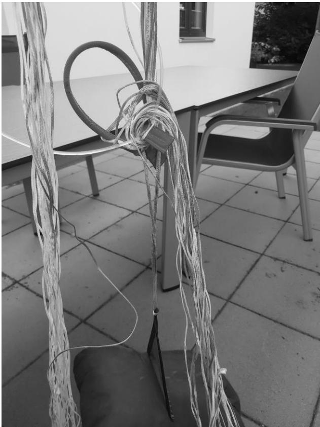
Bild 5 zeigt, dass der stark strukturierte Auslösegriff relativ leicht und reproduzierbar eine feste Verwicklung/Verdrehung mit den Fangleinen des Retters verursachen kann (nachgestellt).
