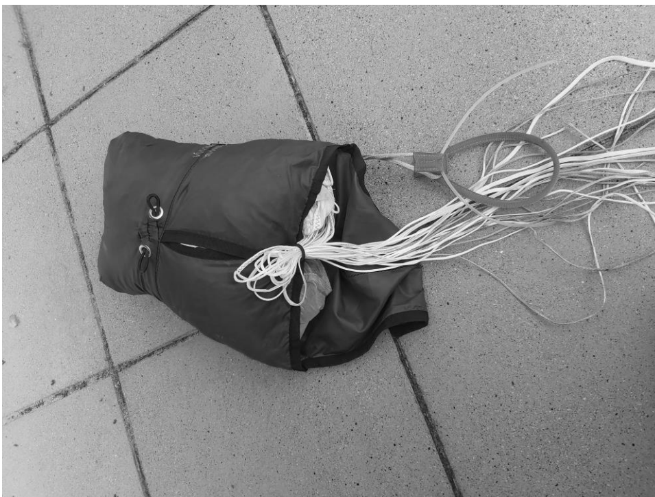
Bild 3 zeigt, dass die Länge der Verbindungsleine den stark strukturierten Griff in den Bereich der ausgelösten Fangleinen, vor dem Freisetzen des Retters, bringen kann.
