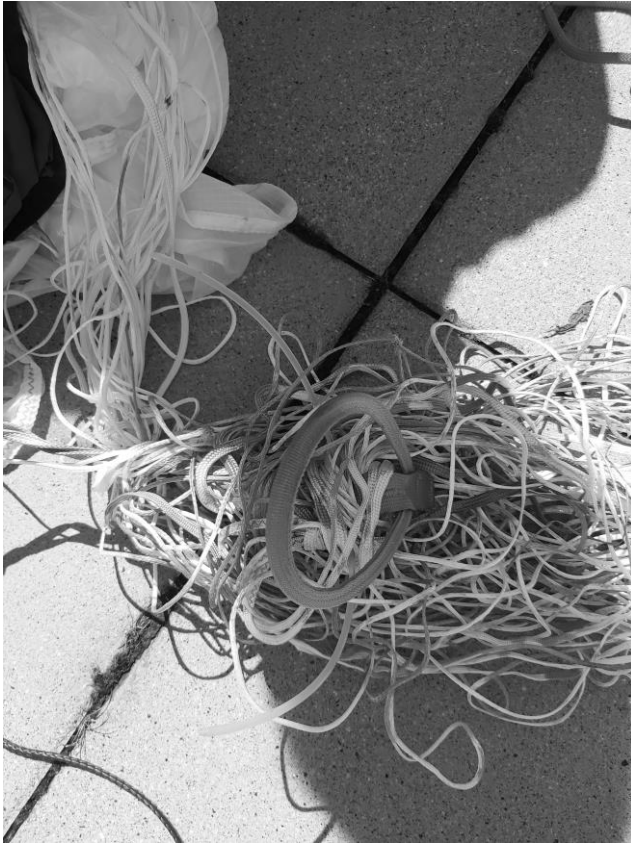
Bild 4 zeigt die starke und feste Verwicklung des Griffes mit den Fangleinen des Retters. In dieser Konfiguration ist die Unfallausrüstung beim DHV zur Untersuchung angekommen.
