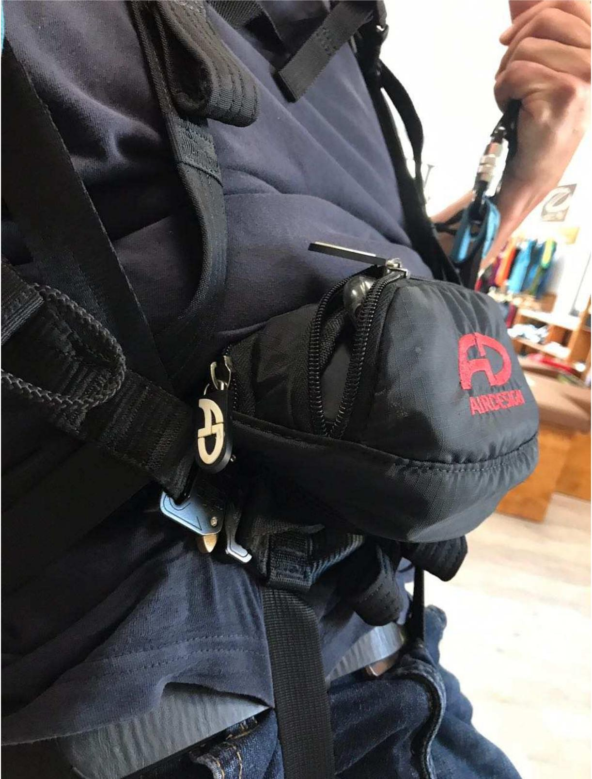
*Abbildung: In der nach vorne gerutschten Pilotenposition, voll in den Beingurten hängend, hat der Pilot zusätzlich das Problem, dass sich das Hip-Bag verklemmt. Das erhöht den ohnehin schon beträchtlichen Kraftaufwand, der für ein Entlasten und Nach-hinten-schieben des Körpers erforderlich ist, erheblich.*
