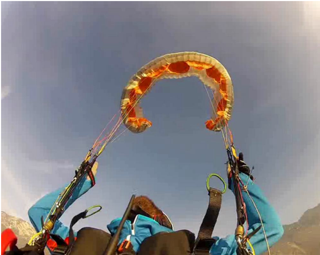
Abbildung 1: Stabiler Frontklapper mit Frontrossette beim Testflug des Unfallgerätes
