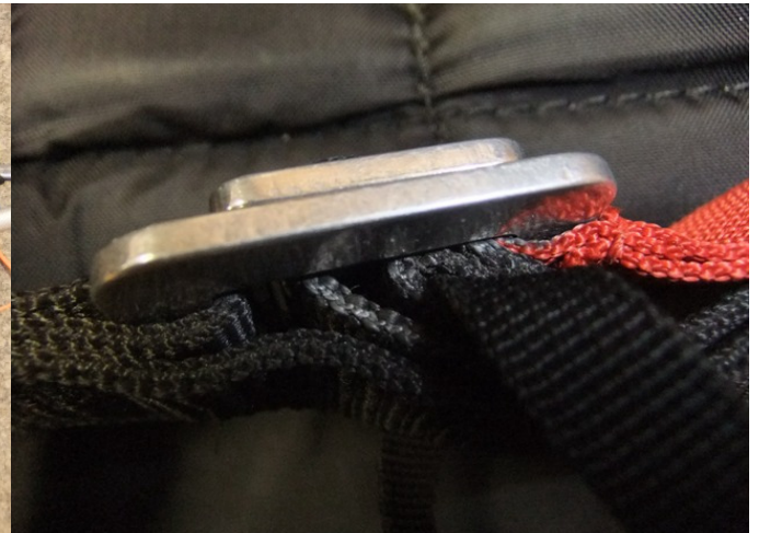
Abbildung 2 (links) Die Einstellung des Brustgurtes war maximal weit.
