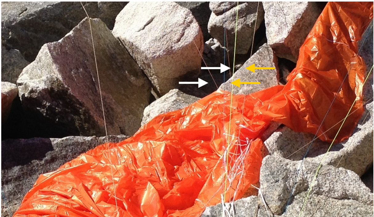
Abbildung 7: Ein Teil der partiell geöffneten Rettungsschirm-Kappe befand sich zwischen den Gleitschirmleinen. Die weißen Pfeile kennzeichnen Leinen, die unterhalb der Rettungsschirmkappe verlaufen, die gelben Pfeile solche, die oberhalb verlaufen.
