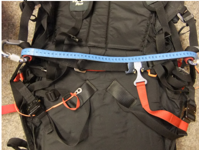
Abbildung 2 (links) Die Einstellung des Brustgurtes war maximal weit.
