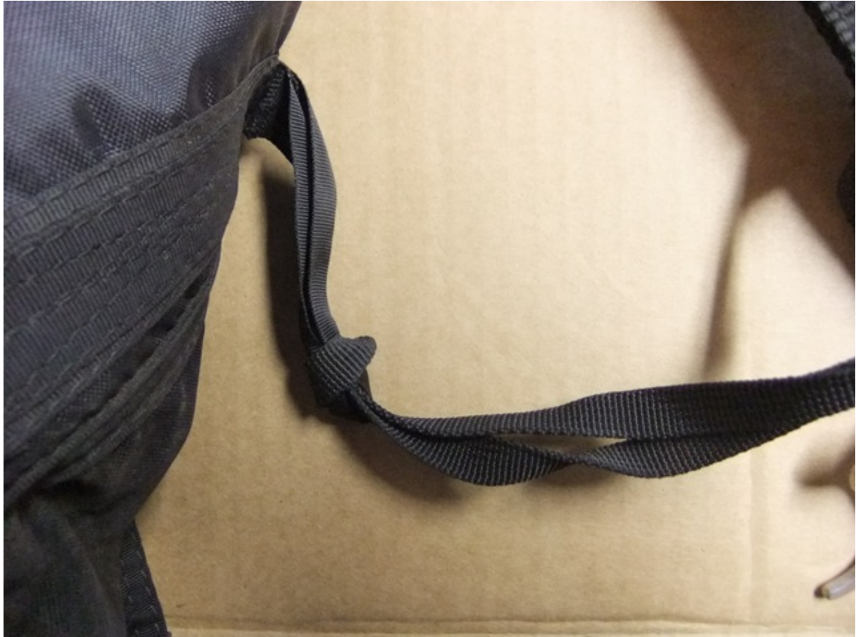
Abbildung 4 zeigt die lockere Verschlaufung der Verbindung Auslösegriff-Innencontainer
