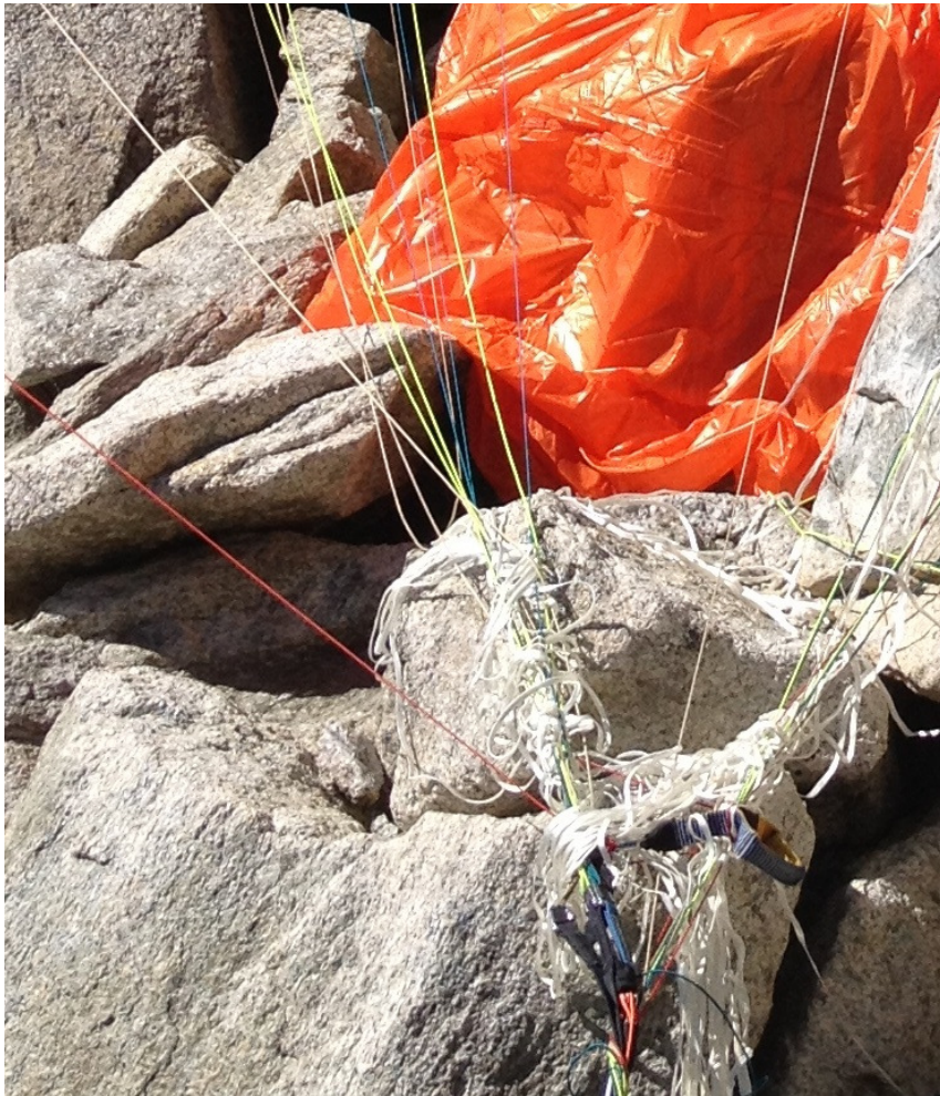
Abbildung 8: Die Anordnung der Fangleinen des Rettungsschirmes.
