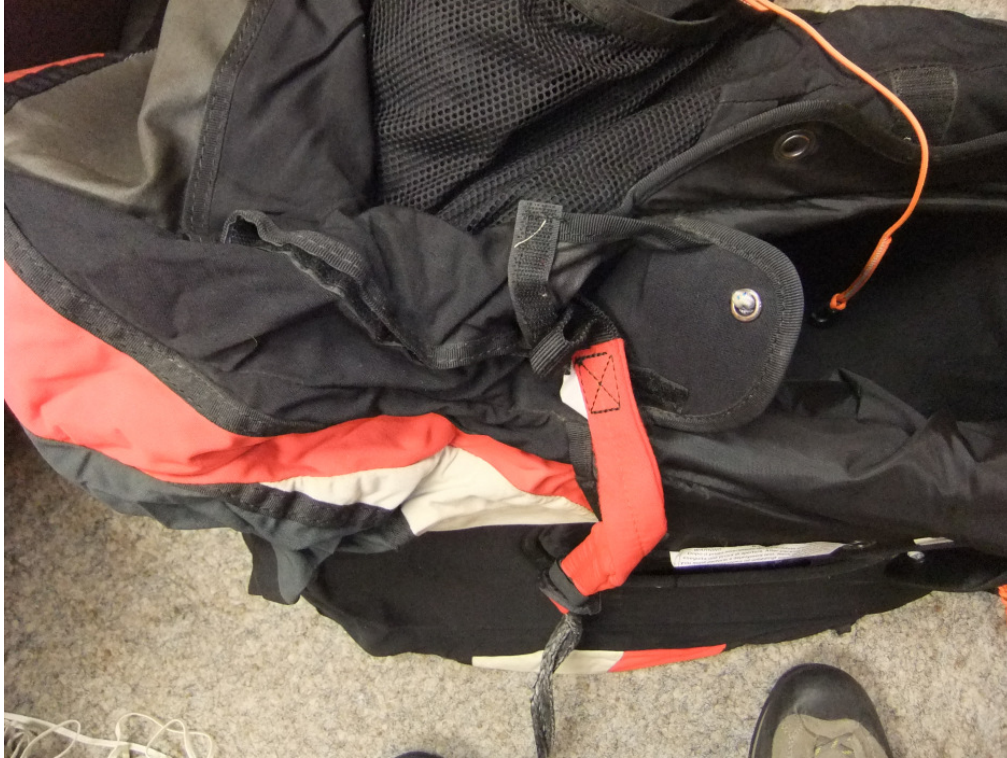
Abbildung 6: Nur der unterste Teil der Klett-Abdeckung der V-Leine war geöffnet
