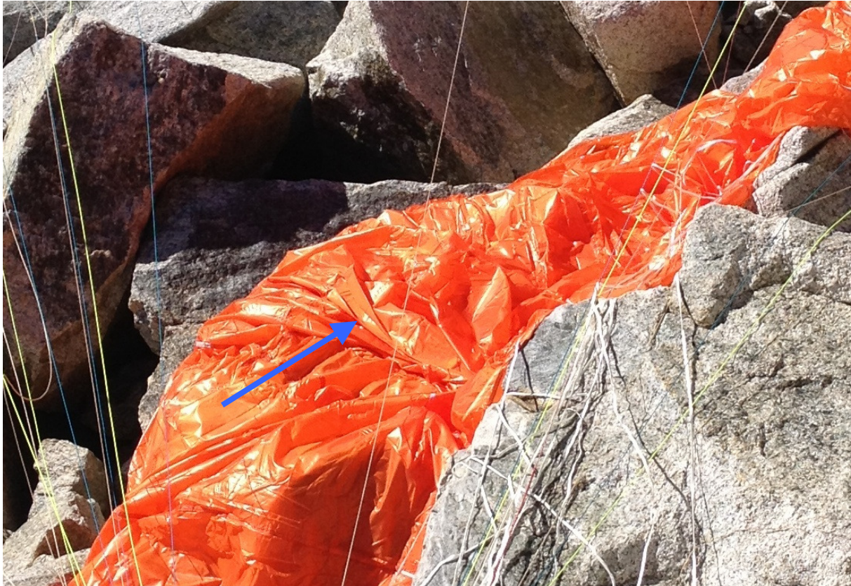
Abbildung 5: Die teilweise noch vorhandene Faltung der Packung des Rettungsgerätes (Pfeil)
