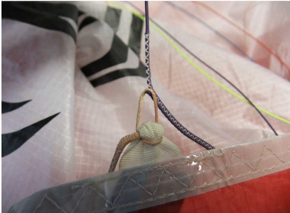
Abbildung 19: Mögliches Verhaken einer unummantelten Galerieleine mit dem steifen, absteigenden Vernähungsende der D-Leine
