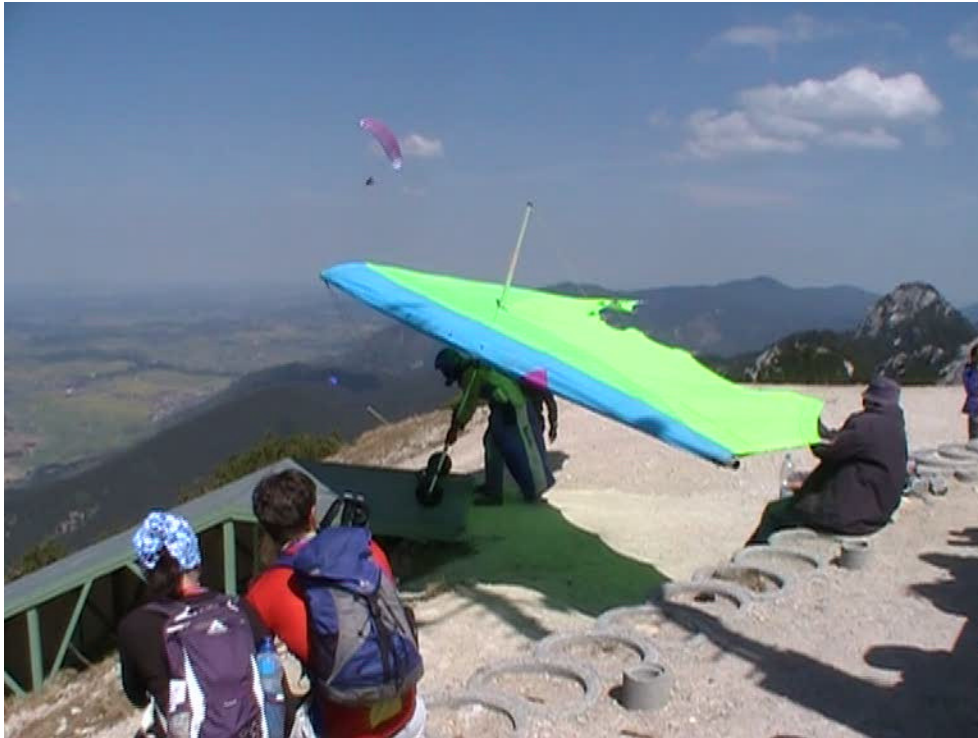
Abbildung 4: Der Gleitschirm rollt/schiebt nach rechts. Es ist kein Steuerinput des Piloten erkennbar (an der Hinterkante des Gleitschirms). Auch die Art der Bewegung der Kappe (schnelle Schiebebewegung nach rechts) deutet darauf hin, dass das Rollen durch Turbulenzeinwirkung verursacht worden ist.
