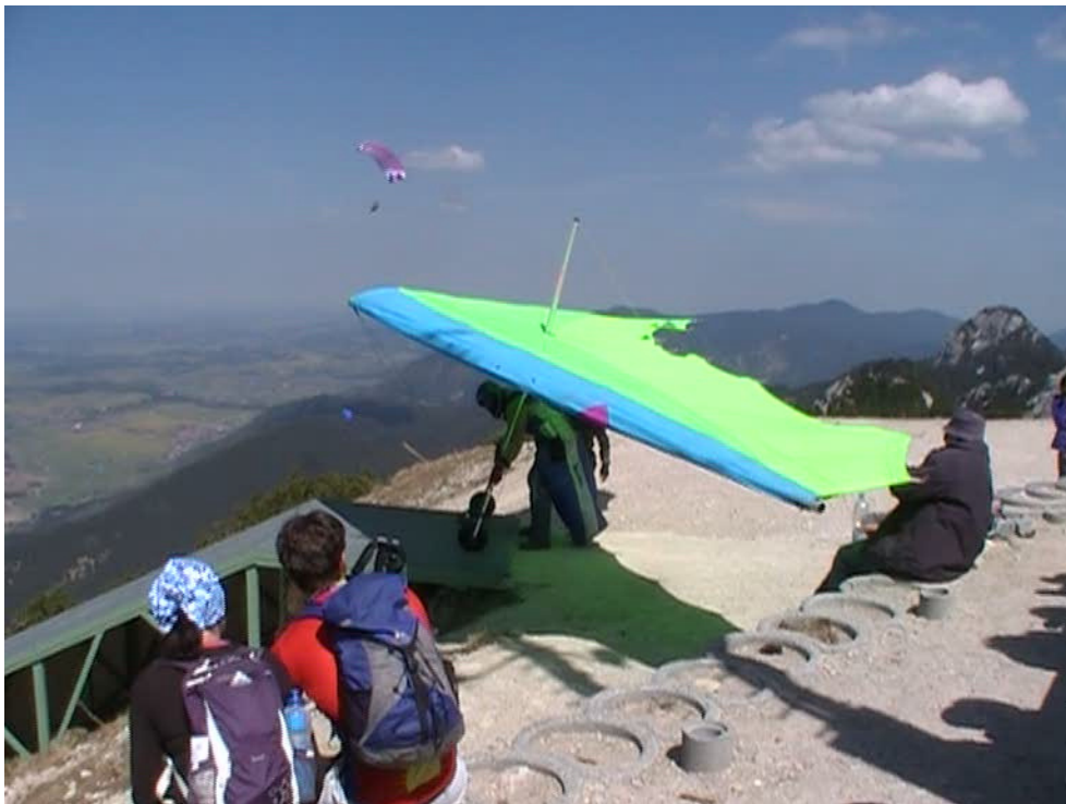
Abbildung 5: Der Außenflügel deformiert von außen nach innen über die gesamte Flächentiefe.
