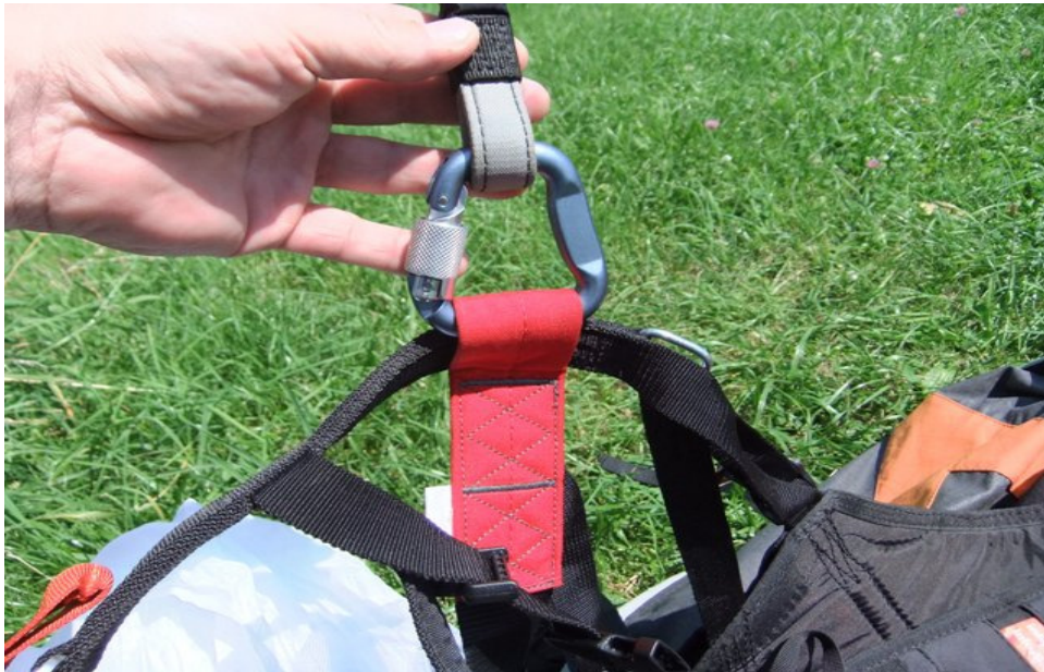
Abbildung 21: Der rechte Tragegurt war so in den rechten Aufhängekarabiner eingehängt, dass die Außenseite mit der Beschleunigerrolle nach innen zeigte. Dabei ergibt sich beim Start zwangsläufig eine Verdrehung der Steuerleine um den Tragegurt.
