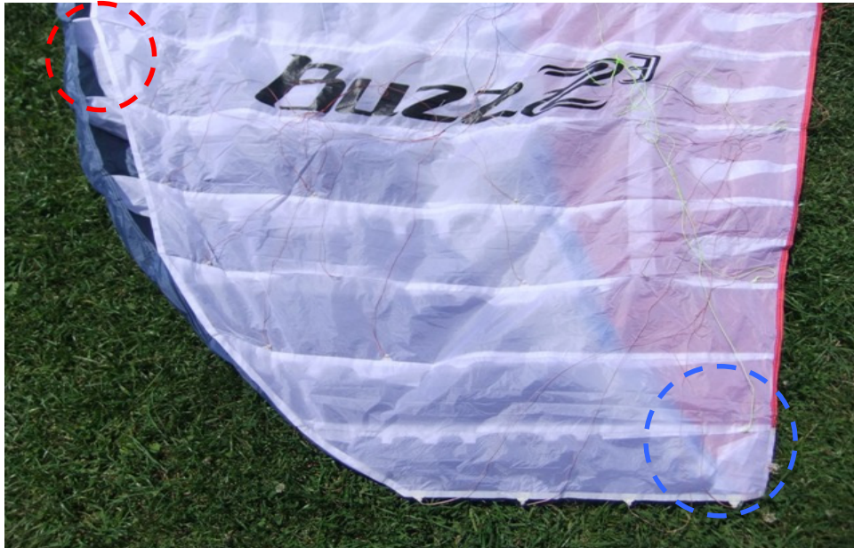
Abbildung 20: Der Außenflügel/Stabilo des Unfallgerätes. Die Versteifungen (Rigid Foils) befinden sich ab der dritten offenen Zelle an der Eintrittskante (roter Kreis), in den Fangleinen verhängt hat sich jedoch der hintere/äußere Teil des Stabilos (blauer Kreis).
