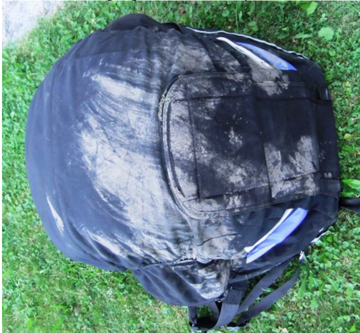
Abbildung 4: Gurtzeug mit Aufprallspuren
