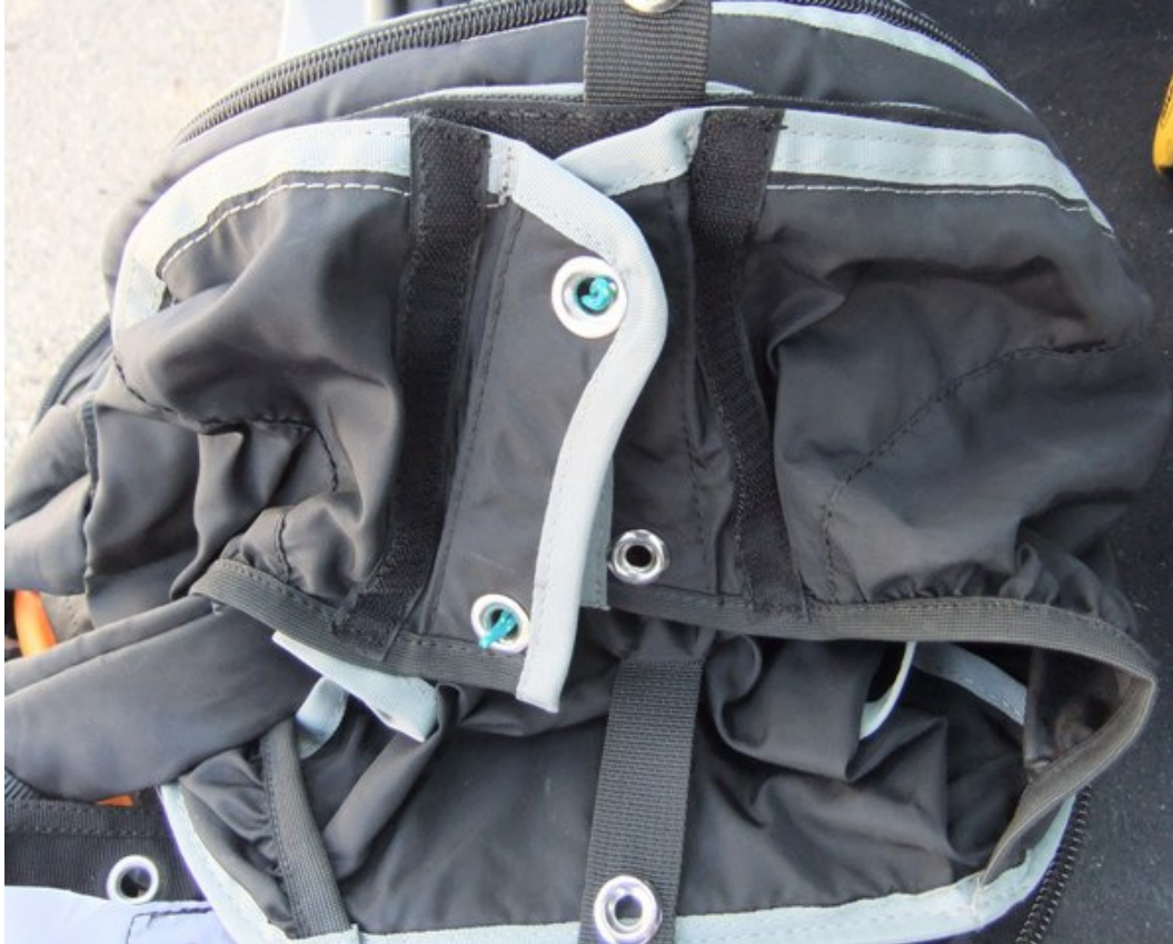
Abbildung 5: Der unbeschädigte und nicht verschmutzte Außencontainer (Frontcontainer)
