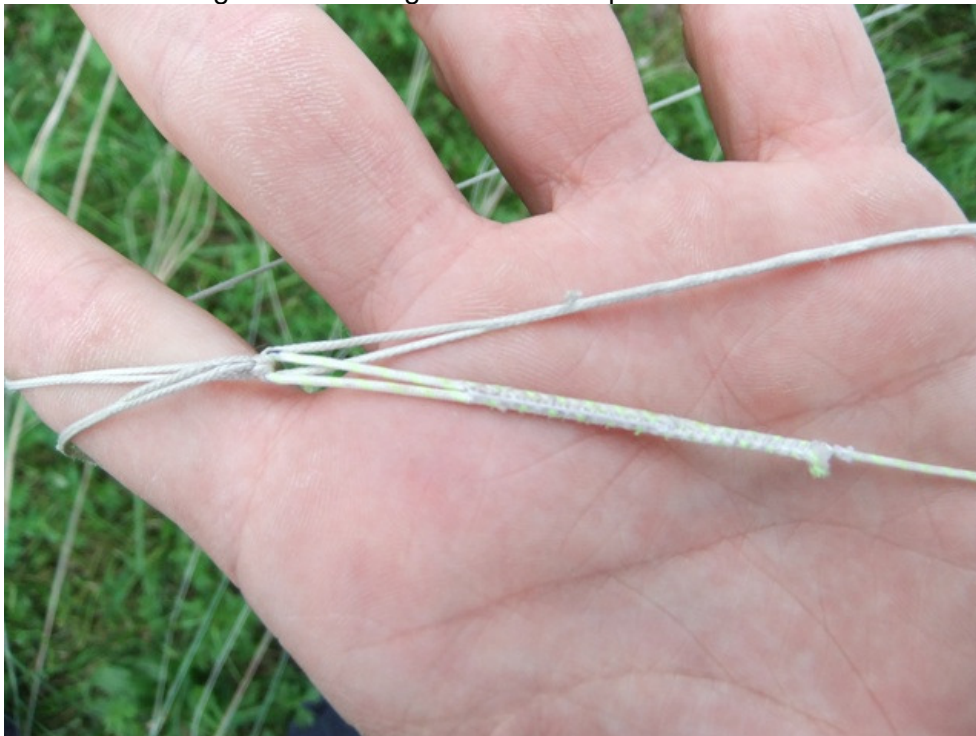
Abbildung 4: Die gelb/weiße, unummantelte Leine entspricht nicht den Spezifikationen der Original-Leinen.
