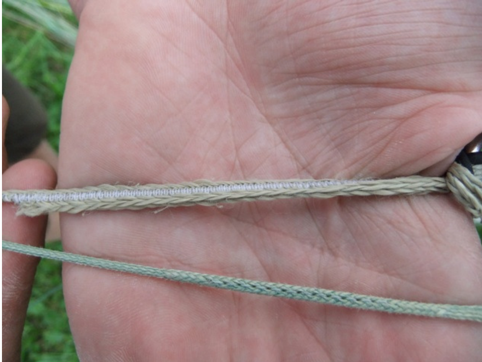
Abbildung 4: Die Original-Stammleine ist gespleißt (unten), die Ersatzleine vernäht
