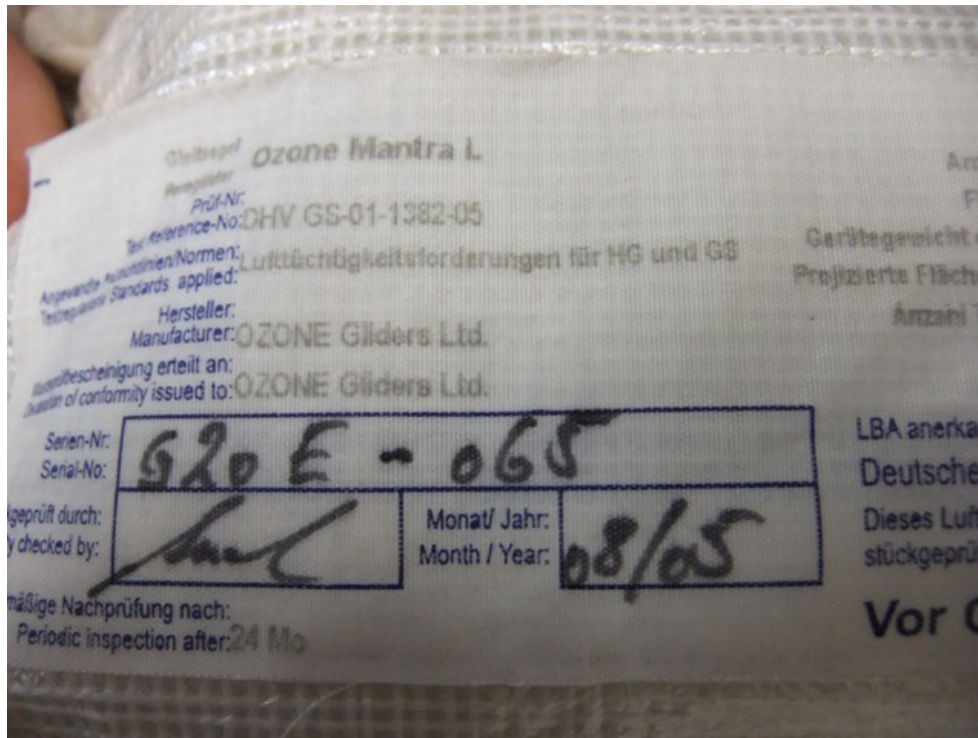
Abbildung 2: Die DHV-Musterprüfplakette des Unfallschirms
