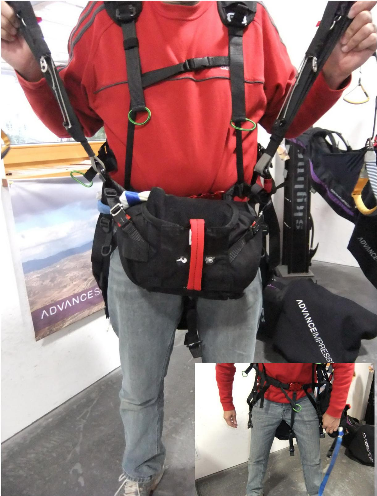
Abbildung 4: Das Herausfall-Sicherungssystem des Gurtzeugs: Bei offenen Beingurten gewährt das zum Brustgurt geführte T-Lock-Band Sicherheit vor einem Herausfallen aus dem Gurtzeug.
