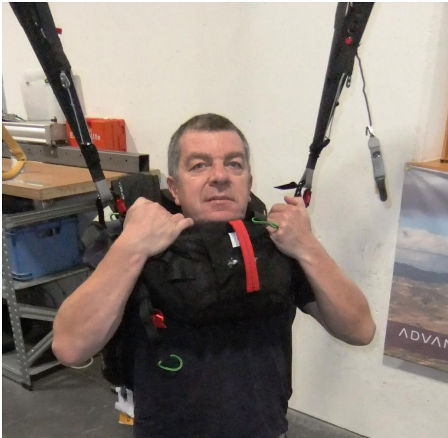
*Abbildung 6: Hängeposition des Piloten nach dem Start bei offenen Bein- und Brustgurten. Bereits nach weniger als einer Minute werden die Schmerzen im Bereich der Achseln schwer erträglich.*
