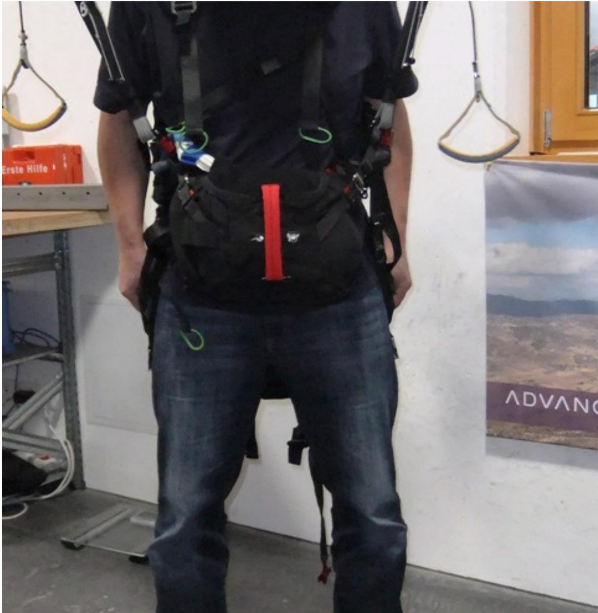
*Abbildung 3: Rekonstruktion mit baugleichem Gurtzeug: In der abgebildeten Weise hatte der verunglückte Pilot das Gurtzeug angelegt.*
