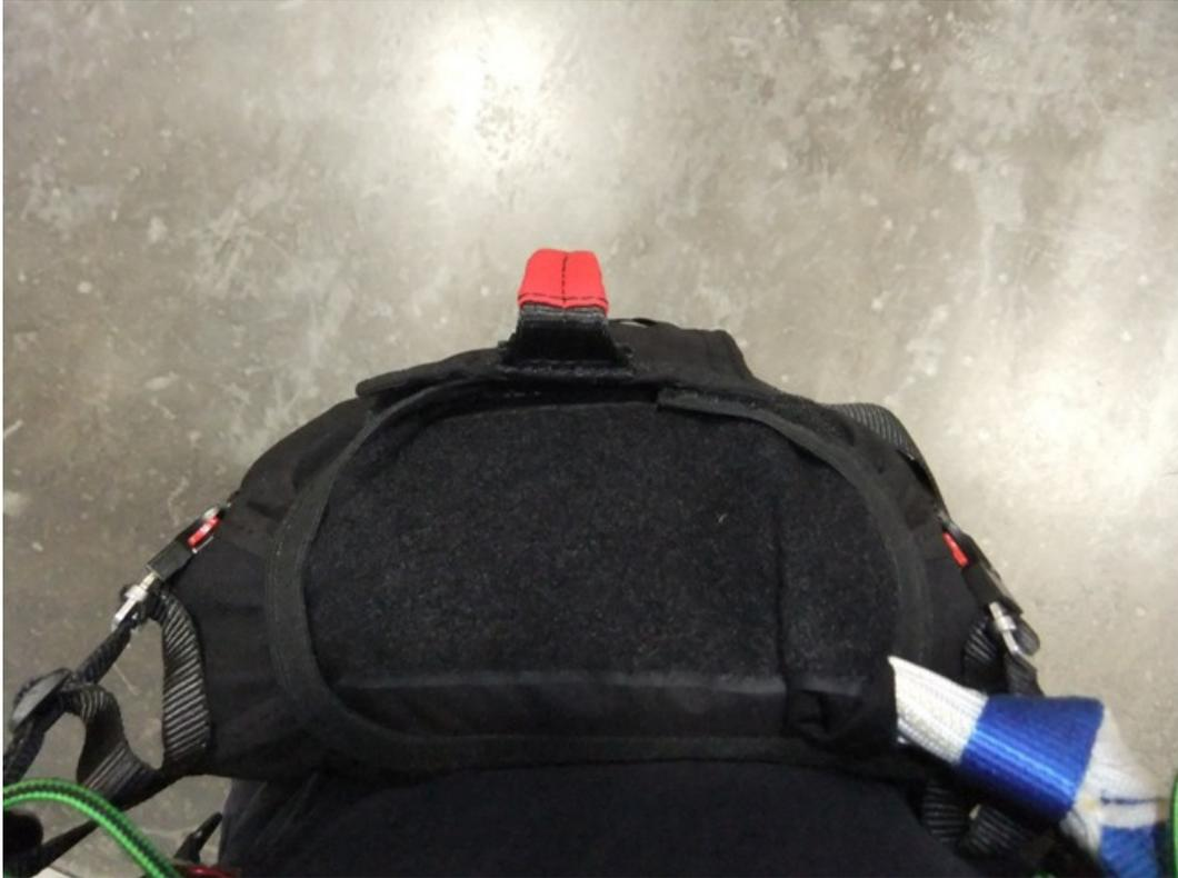
*Abbildung 5: Bei eingehängtem Frontcontainer ist die Sichtkontrolle auf das Gurtsystem stark erschwert.*
