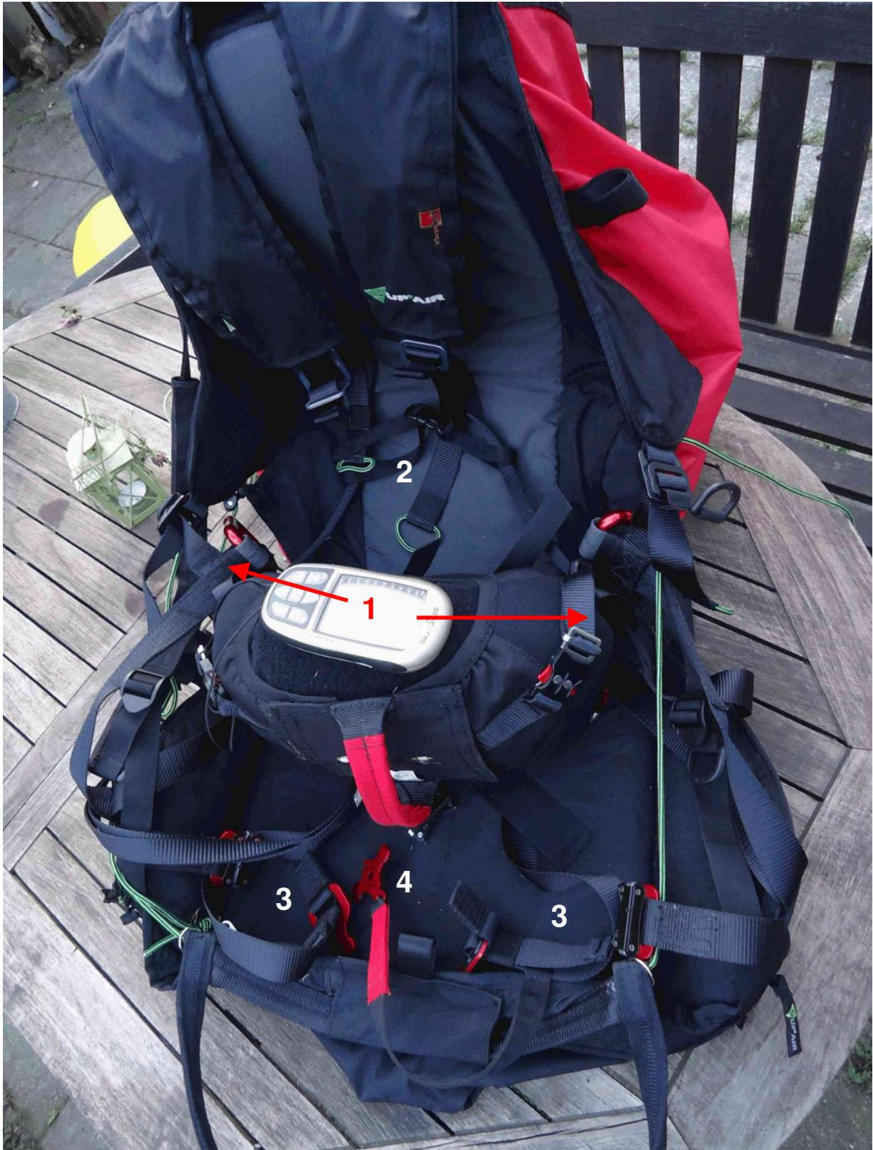
*Abbildung 2: Das Unfallgurtzeug, so wie es am Unfallort aufgefunden wurde: Der Frontcontainer ist beidseitig eingehängt (1), der Brustriemen (2) geschlossen. Beide Beingurte (3) und der Brustgurt (4) sind unverschlossen.*
