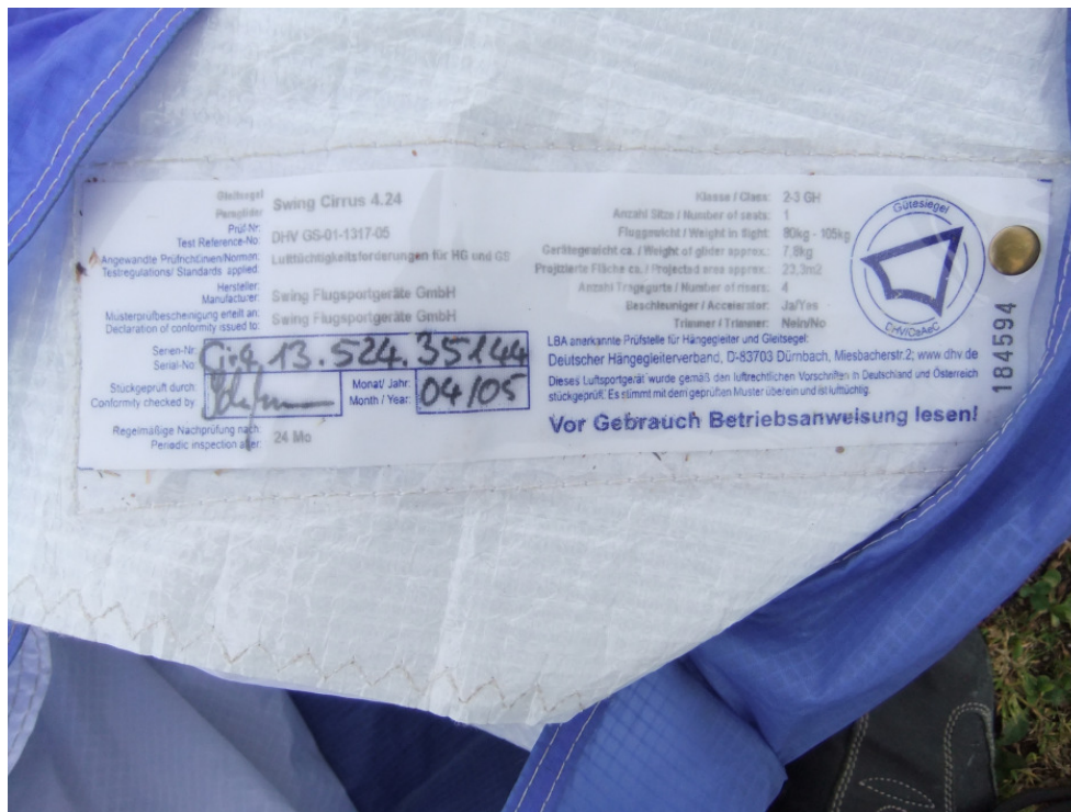
Abbildung 1: Die Musterprüfplakette des Unfallgerätes
