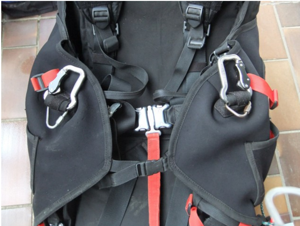
Abbildung 5: Das Unfallgurtzeug. In den Hauptaufhängungen sind die Austri-Alpin Stahlkarabiner und die Dreieck-Schäkel für die Montage der Schleppklinke befestigt.
