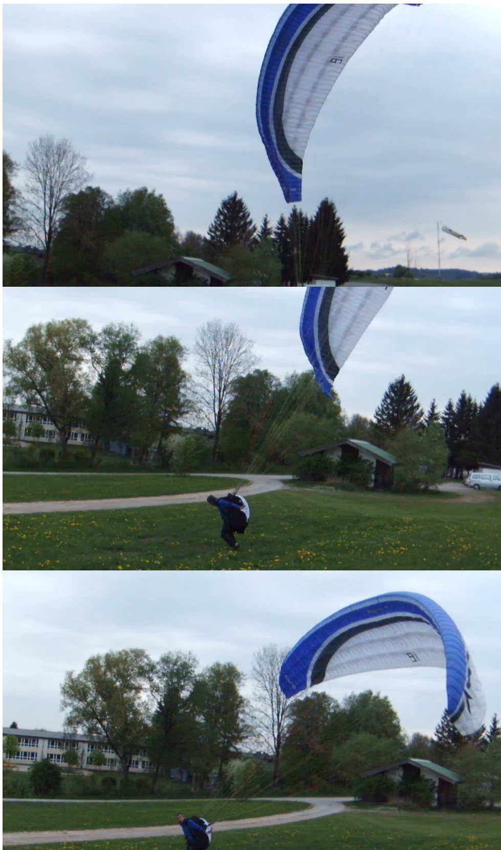
Bildreihe 3: Startversuche des DHV mit dem Unfallgerät im flachen Gelände. Zunächst (oben) steigt der Schirm verzögert bis über den Piloten, um dann, im Startlauf (mitte, unten), wieder nach hinten zu kippen.
