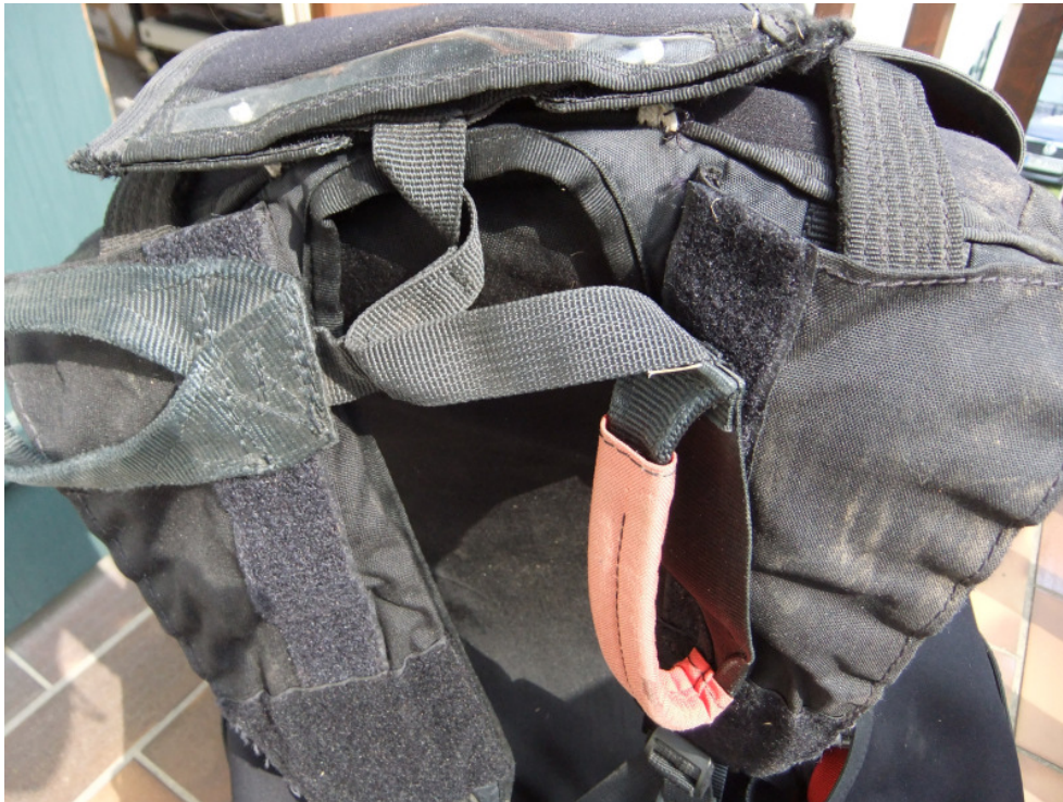
Abbildung 7: Der Top-Container des Gurtzeugs mit Auslösegriff. Es ist von außen nicht erkennbar, dass im Außencontainer des Gurtzeuges kein Rettungsschirm eingebaut ist.
