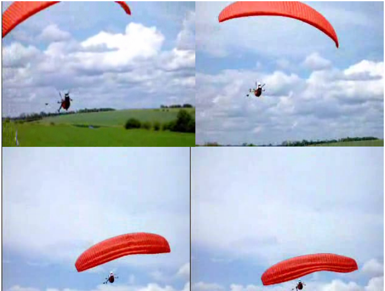
Bildreihe 9: Typischer Sackflug in der ersten Steigflugphase an der Winde. Es kommt nicht zum „Einrollen“ des Außenflügels. Der Pilot wird immer weiter vor den Schirm gezogen, bis der Anstellwinkel so groß ist, dass ein Strömungsabriss erfolgt. Auf die typischen Merkmale dieses Sackfluges werden die Windenführer trainiert; markantes Abflachen des Steigwinkels, und Vergrößerung der Silhouette des Schirmes aus der Position des Windenführers.
