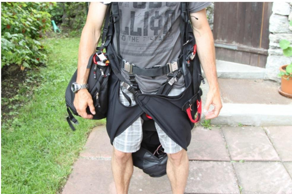
Abbildung 4: Genie Race mit geschlossenen Gurten und fixierter „Schürze“ des Beinsacks.
