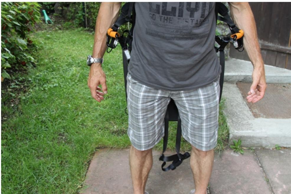
Abbildung 2: Bei solchen Gurtzeugen ist ein Start mit offenen Gurtzeug-Verschlüssen, wie im Bild, praktisch unmöglich.
