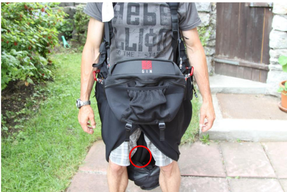
Abbildung 6: Genie Race mit offenen Gurtverschlüssen, aber geschlossener „Schürze“ des Beinsacks und eingehängtem Front-Cockpit. Das eingehängte Cockpit verstärkt zusätzlich den Eindruck, alles sei ordnungsgemäß verschlossen. Und zwar für den Piloten ebenso, wie für einen Dritten, der einen kontrollierenden Blick auf das Gurtzeug wirft. Das offene Verschluss-System, es befindet sich im Beinsack (roter Kreis) bleibt unbemerkt.
