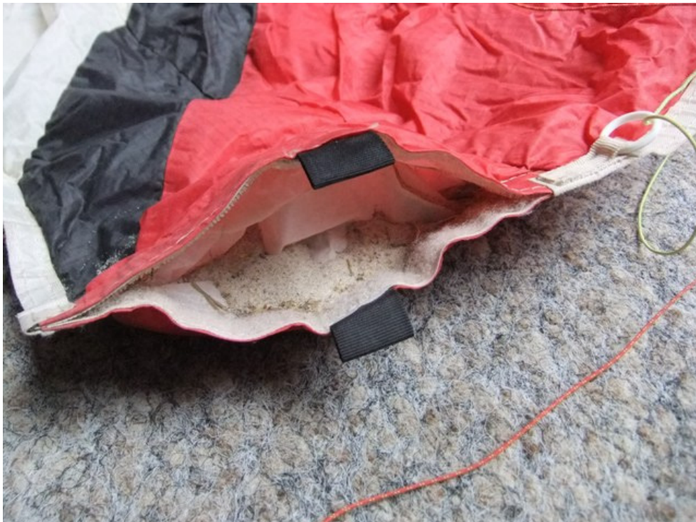
Abbildung 1: Der rechte Stabilo des Unfallgerätes. In diesem befanden sich etwa 1,5 kg Sand.
