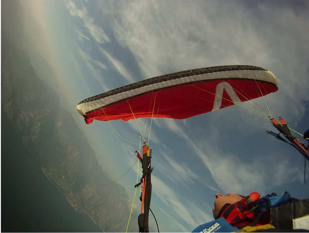
Abbildung 5: Der Testpilot muss massiv aktiv eingreifen, um den Verhänger zu lösen und die schnelle Drehbewegung zu stoppen.
