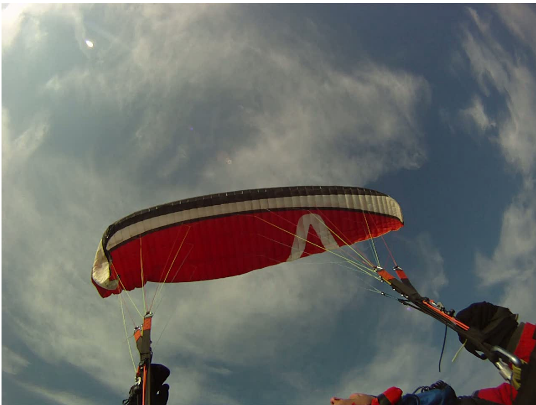
Abbildung 4: Der rechte Stabilo verhängt sich mit den Leinen des Außenflügels, der Schirm dreht sofort zur verhängten Seite.
