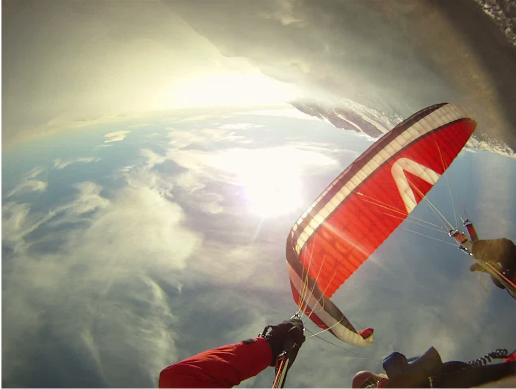
Abbildung 3: Einklappen der kurvenäußeren Seite des Unfallschirmes bei einem Wing Over.
