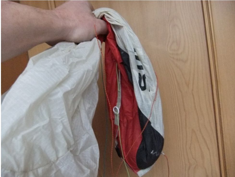
Abbildung 1: Der rechte Stabilo des Unfallgerätes. In diesem befanden sich etwa 1,5 kg Sand.
