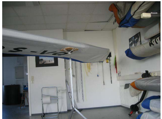
Vertauscht montiertes Flügelrohr
