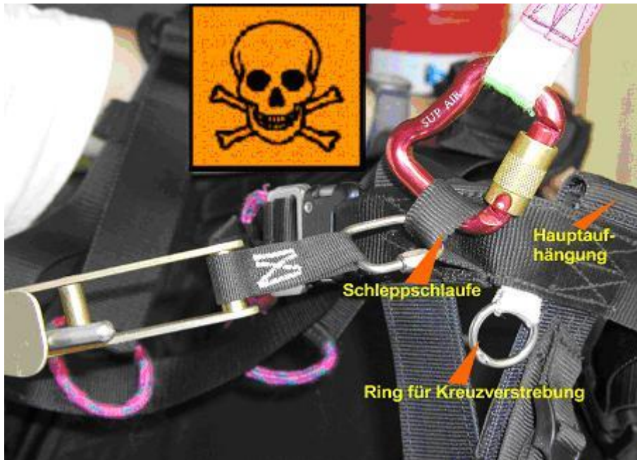
Abbildung 3: Hauptaufhängung und Schleppklinke sind in den Schleppschlaufen montiert. Lebensgefahr, Schleppschlaufen werden nur mit 300 kg geprüft
