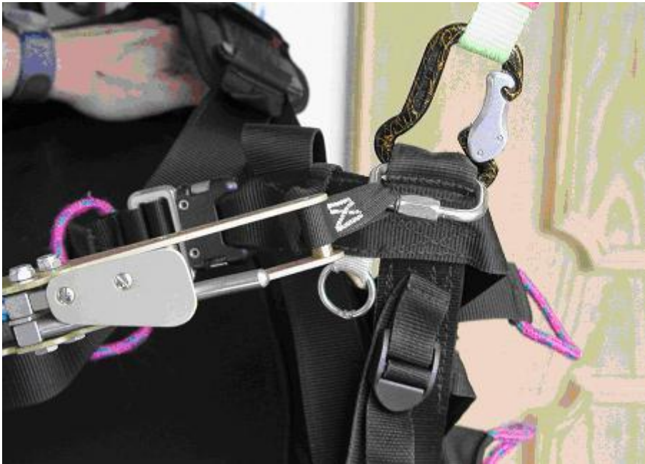
Abbildung 5: Sichere Befestigung der Schleppklinke mit einem Schraubschäkel an der Hauptaufhängung. Korrekte Anbringung der Aufhängekarabiner an der Hauptaufhängung.
