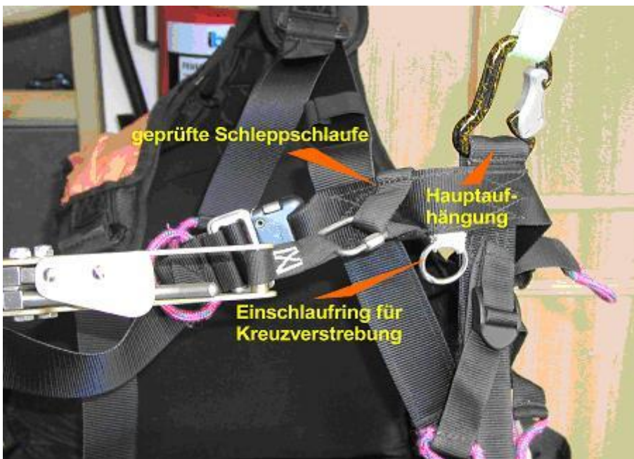
Abbildung 6: Sichere Befestigung der Schleppklinke an der geprüften Schleppschlaufe. Korrekte Anbringung der Aufhängekarabiner an der Hauptaufhängung.
