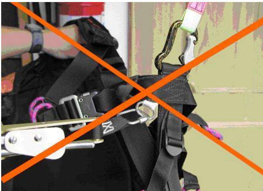
Abbildung 4: Befestigung der Schleppklinke in den Ringen der Kreuzverstrebungsbefestigung. Gefahr! Herausreißen während des Schleppvorganges möglich.
