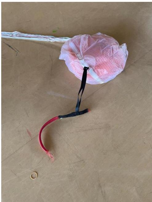
Der Hersteller wurde vom DHV informiert. Der defekte Griff ist jedoch nicht mehr im Originalzustand verfügbar. Es kann deshalb nicht überprüft werden, ob der Abriss durch Herstellungsfehler oder einen Vorschaden verursacht worden ist. Dem Hersteller sind keine weiteren Fälle bekannt.
