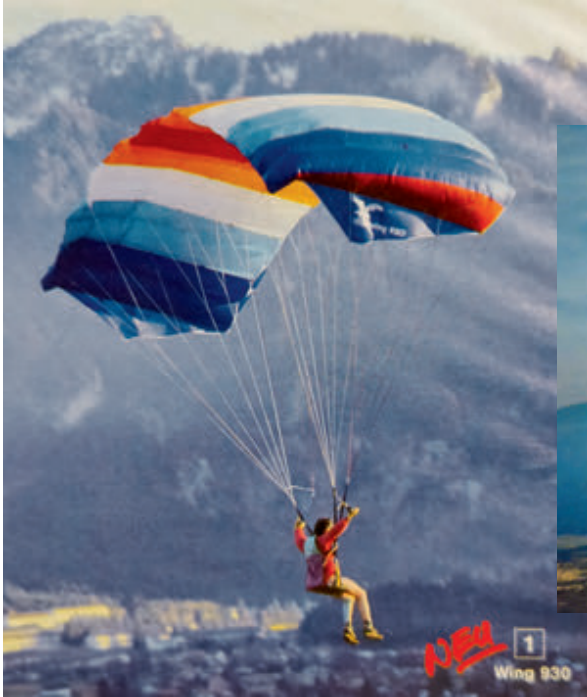
Salewa 930 mit Gleitzahl 1:3 - ein hochwertiges Gerät seiner Zeit
