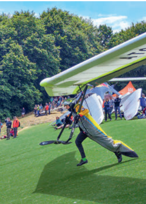
Ein Starrflügel und ein Hochleister Flexi (Bild links & mitte) starten mit ähnlichem Anstellwinkel. Die Nase ist jedoch deutlich unterschiedlich hoch. Der Längsneigungswinkel der Kielstangen täuschen konstruktionsbedingt nur unterschiedliche Anströmwinkel vor. Die Profilsehne des „Atos“ ist auch aufgrund der gesetzten Klappen steiler als die Kielstange. Bei einem Floater (Bild rechts) mit hoher Kieltasche muss die Nase nochmal ein gutes Stück höher, um einen ausreichend hohen Anstellwinkel und damit eine gut und sicher zu erlaufende Abhebegeschwindigkeit zu erreichen.
