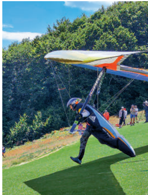
Ein Starrflügel und ein Hochleister Flexi (Bild links & mitte) starten mit ähnlichem Anstellwinkel. Die Nase ist jedoch deutlich unterschiedlich hoch. Der Längsneigungswinkel der Kielstangen täuschen konstruktionsbedingt nur unterschiedliche Anströmwinkel vor. Die Profilsehne des „Atos“ ist auch aufgrund der gesetzten Klappen steiler als die Kielstange. Bei einem Floater (Bild rechts) mit hoher Kieltasche muss die Nase nochmal ein gutes Stück höher, um einen ausreichend hohen Anstellwinkel und damit eine gut und sicher zu erlaufende Abhebegeschwindigkeit zu erreichen.
