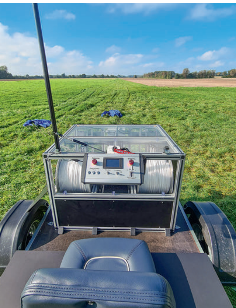
Der Arbeitsplatz des Windenfahrers. Den Piloten und die Mechanik jederzeit optimal im Blick
