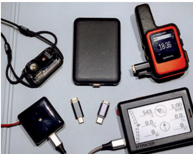
Eines für alle: einheitliche Magnetadapter an Varios, Tracker, Lampe und Powerbank
