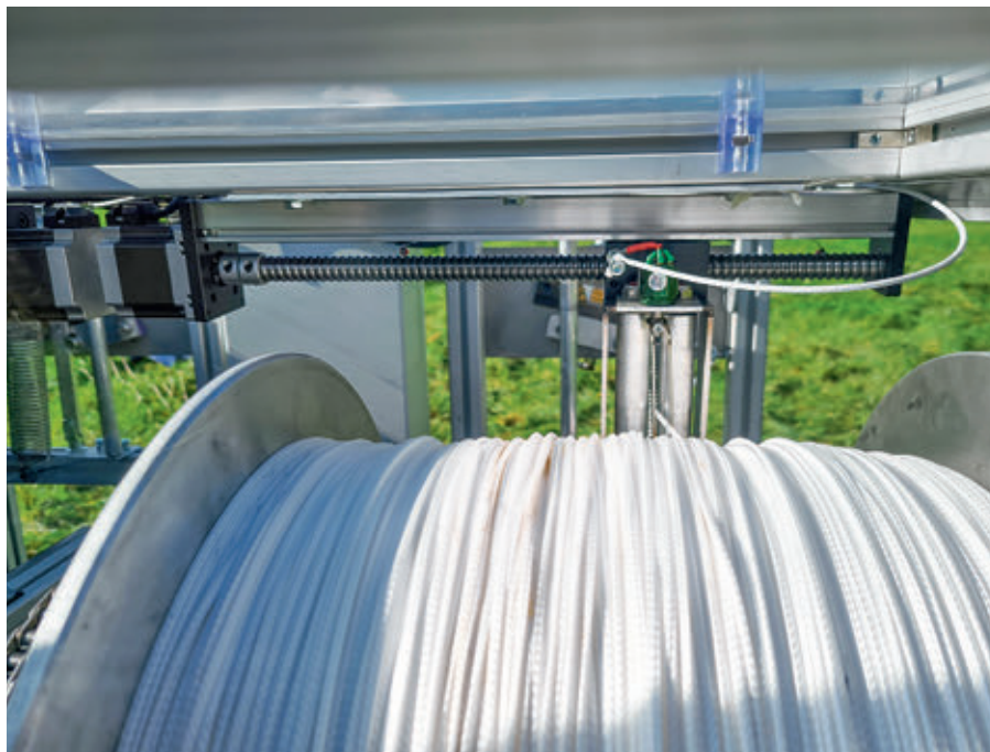
Das Innenleben der Winde: breite Trommeln mit 1.500 m Seil und der Seilführung über Linearschlitten.
