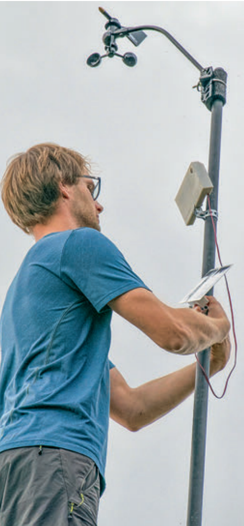
Windsensor und Webcam sind an einem Windsurfmast befestigt.
