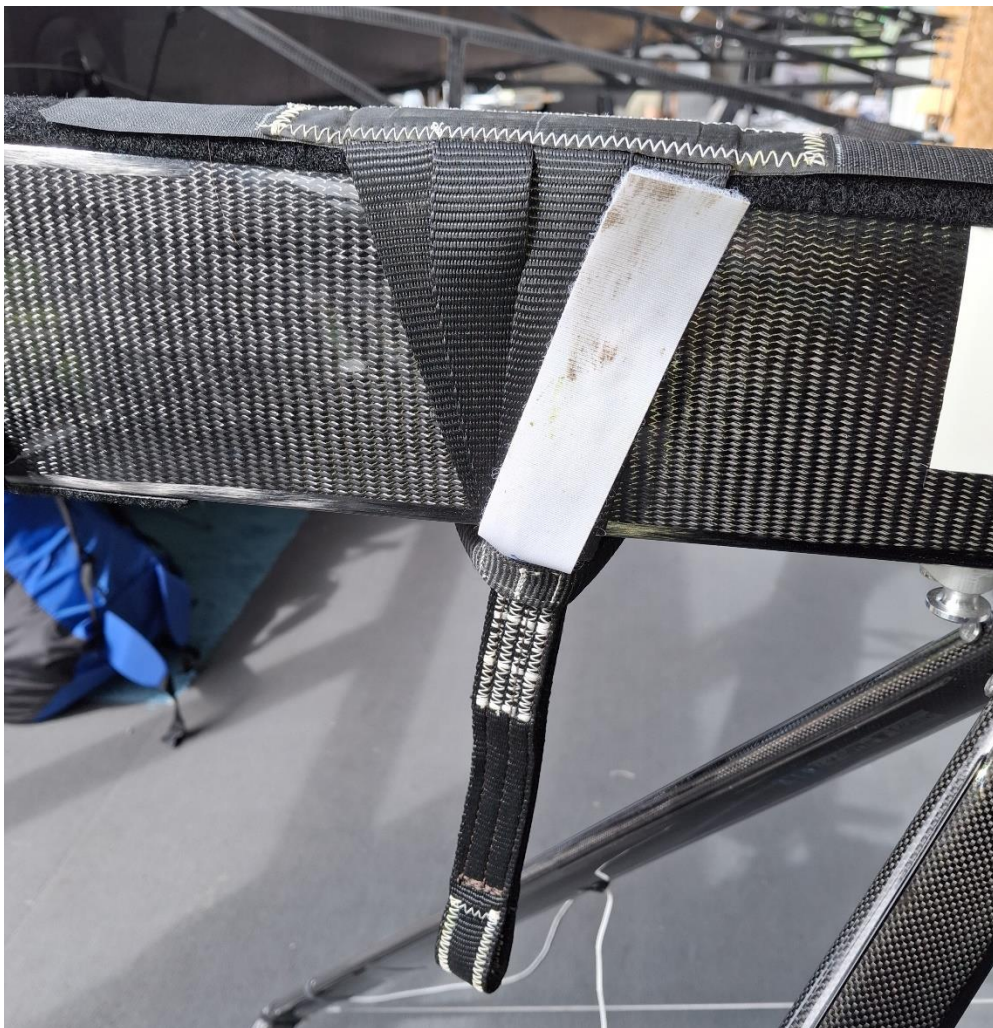
Abbildung 1: Korrekt montierte und gesicherte Hauptaufhängung
