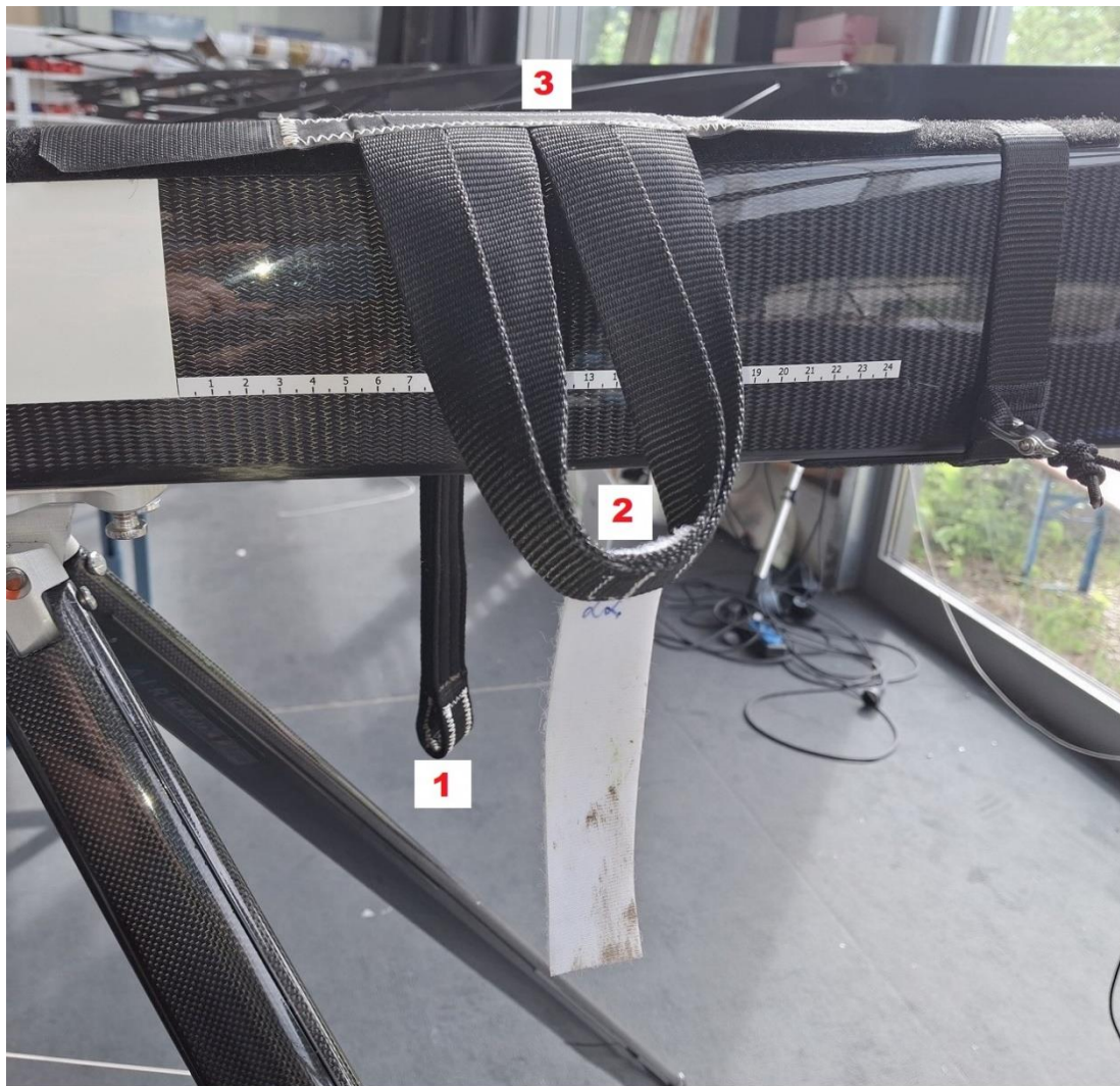
Abbildung 2, Unfall-Konfiguration: Die Aufhängung für die Verbindung zum Gurtzeug (1) ist nicht durch die Schlaufe (2) geführt. Die Aufhängung ist nicht gesichert und wird nur von dem Klett-Streifen an der Oberseite des Kielrohrs (3) gehalten. Dieser Klett ist für die Fixierung der Trimm-Einstellung des Atos vorgesehen. Bei Last auf der Aufhängung öffnet der Klett und die Aufhängung löst sich vom Drachen. In der Konfiguration ohne Segel (wie auf den Abbildungen) ist dieser Fehler sehr offensichtlich und nicht zu übersehen.
