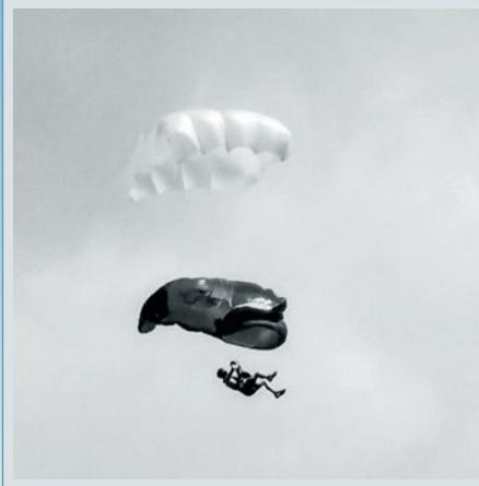
Der Schirm ist flugunfähig und keine Scherenstellung mehr zu erkennen.
