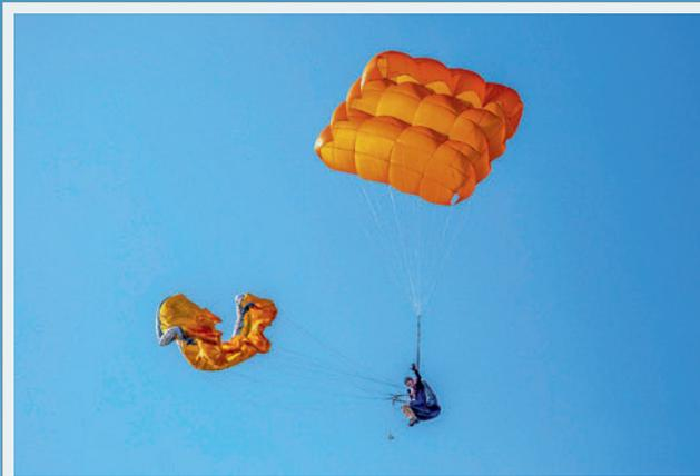
Gleitschirm ist flugunfähig, der Retter über dem Piloten. Eine aufrechte Haltung ist einfach, fast automatisch, eingenommen.
