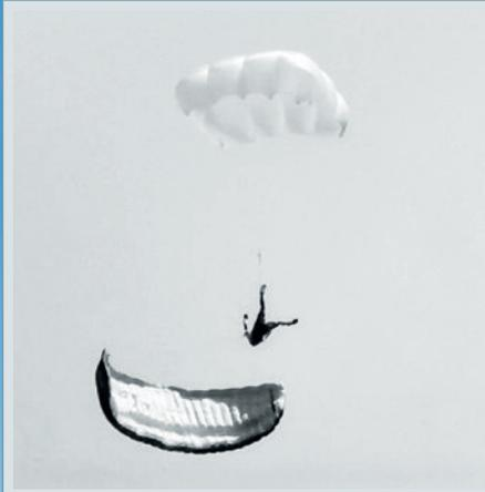
Scherenstellung mit hohen Sinkwerten. Der Pilot hat Schwierigkeiten den Gleitschirm durch bspw. einen C-Leinen-Stall flugunfähig zu machen und befindet sich in einer für einen Aufschlag ungünstigen Haltung.
