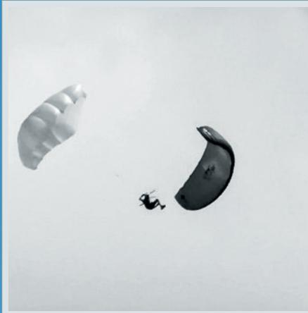
Nach Auslösen des Rettungsgerätes gerät der Pilot in Rücklage.
