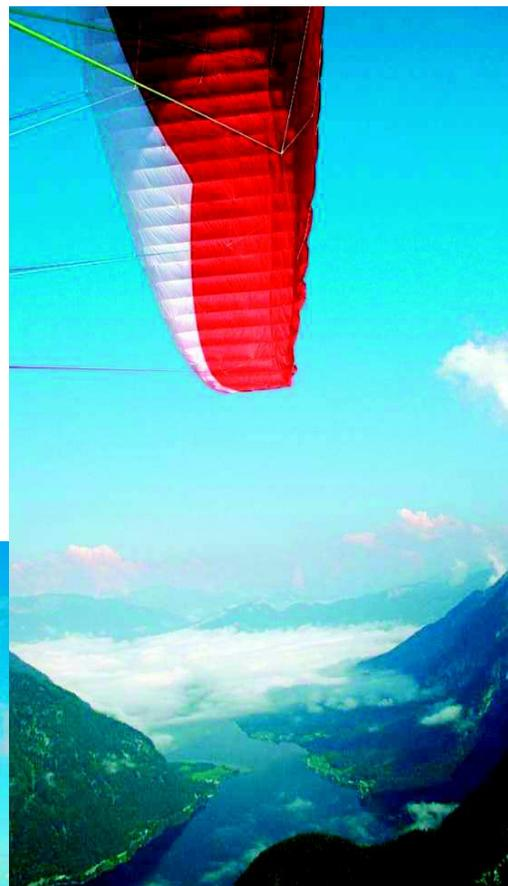
Bodeninversion im Herbst, der Bodennebel muss noch aufgelöst werden, bevor die Thermik so stark wird, dass sie für unsere Fluggeräte wirklich nutzbar wird. Die Kumuluswolken rechts sind an den hohen Bergflanken entstanden. Wer es schafft, sie zu erreichen, kann schon um diese frühe Zeit thermisch fliegen.
