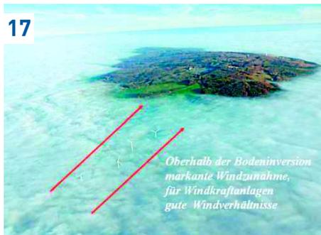
Abbildung 17: In einer sehr flachen Bodeninversion hat sich Hochnebel gebildet. Die Windkraftanlagen überragen die Inversionsobergrenze und liegen so im Bereich der höheren Windgeschwindigkeit.
