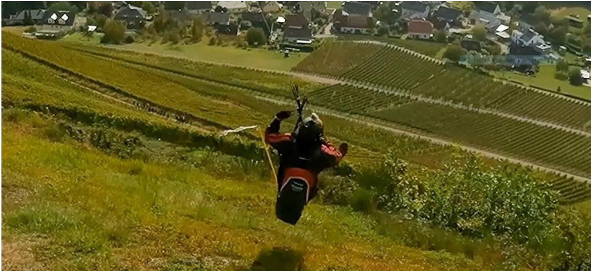
*Abbildung (Symbolbild): Eingedreht (vertwistet) abheben ist grundsätzlich riskant. Wegen der überkreuzten oder blockierten Bremsen ist eine Kontrolle des Gleitschirms schwierig. Oft wird versehentlich die falsche (weil überkreuzte) Bremse zur Korrektur des Flugwegs bestätigt. Das führt häufig zu einer Drehung Richtung Hang und zum Crash.*
