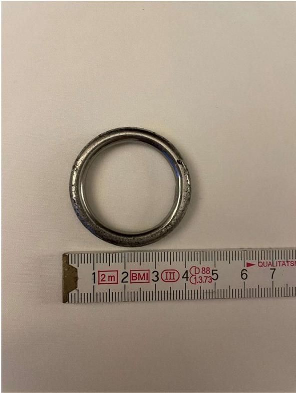
Bild 3 zeigt die an Vorseilen standardmäßig verwendeten Stahlringe zum Einhängen der Klinke in das Schleppeil mit 4 cm Außen- und 3,5 cm Innendurchmesser.
