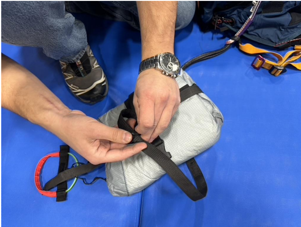
Einbau des Gurtes
