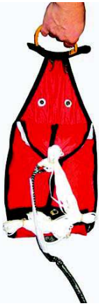
Abbildung 2: Der Innencontainer mit gepacktem Rettungsschirm und Auslösegriff. Das Ganze ist ziemlich kompakt, die Verbindung Griff-Innencontainer mit unter 25 cm erfreulich kurz. Der Griff kann nicht mehr an der falschen Schlaufe des Innencontainers angebracht werden, weil es hier nichts mehr zu schlaufen gibt. Auch Fehler beim Verschließen der Splinte (es wird nicht darauf geachtet, dass zuerst der Splint den Außencontainer öffnet und erst dann Zug auf den Innencontainer kommt) sind hier nicht mehr möglich.
