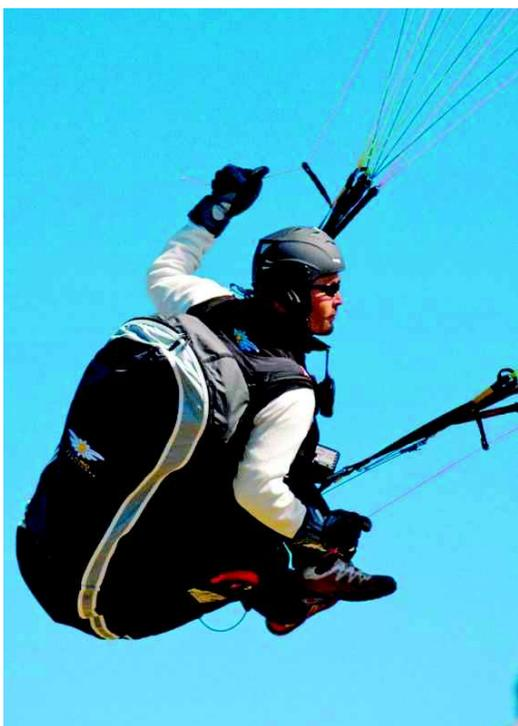
Der Sitzgurt hat keinesfalls ausgedient: Im dynamischen Kurvenflug ist bei seitlicher Anströmung der Luftwiderstand deutlich geringer als beim Liegegurt. Wer Spaß an schnellen Kurven, engen Thermikkreisen und Freestyle hat, wird sich für ein kompaktes Sitzgurtzeug entscheiden.
