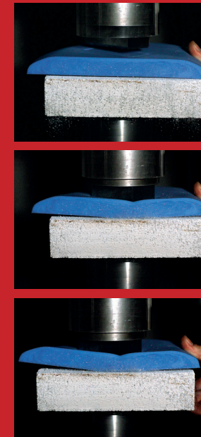
Bilder 5-8: Test gemäß Motorrad-Protektor-Norm, Gasbeton-Platte mit Protektor
