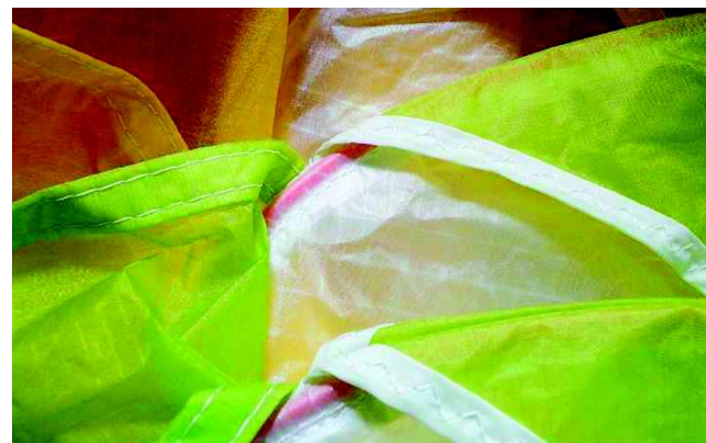
Tuchmix: Bei diesem Leichtschirm (Lightning von U-Turn) ist ein Mix aus leichtem 27-Gramm- und mittlerem 36-Gramm-Tuch verbaut. Das Leichttuch der nicht aufgehängten Rippen ist an den größeren Ripstop-Kästchen zu erkennen.
