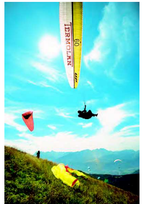
Stand der Technik 2001. UP Gambit C mit 5 Leinenebenen, 64 Zellen und Streckung 6,1.
