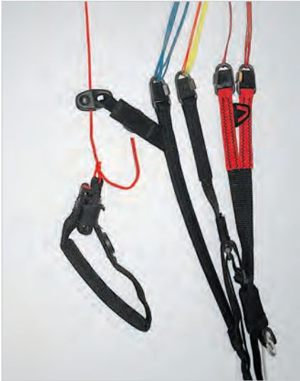
↑ Knoten ist an der Markierung. Dies ist aber wegen möglicher Schrumpfung keine Garantie dafür, dass die Einstellung passt!
