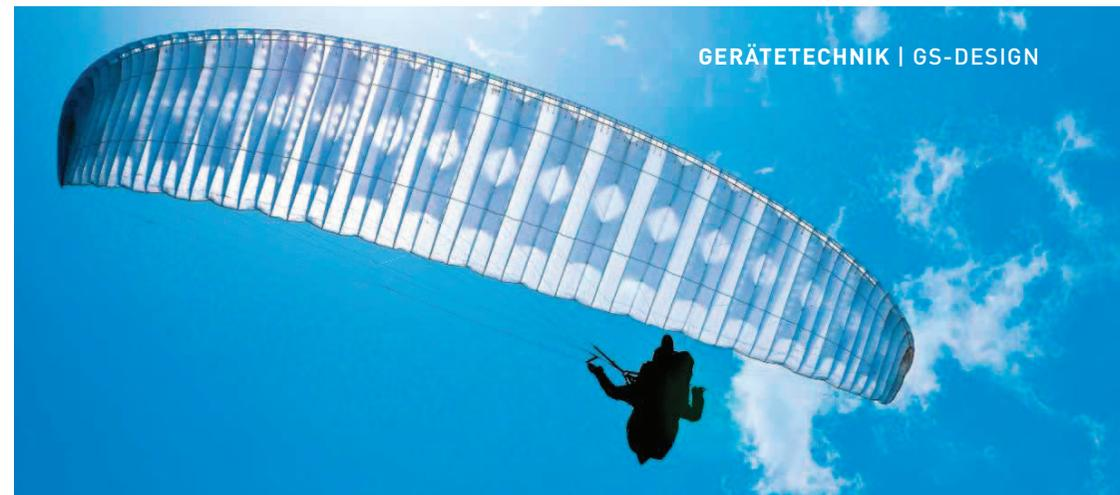
lenkpunkten aus. Dabei gibt es zwei Möglichkeiten: Entweder man baut die Stäbchen entlang der Naht nahe des Obersegels ins Profil ein oder man bildet damit einen Bogen in Richtung Unterkante, in dessen Zentrum der Anlenkpunkt liegt. Die beiden Enden des Bogens übertragen die Last des Anlenkpunktes auf das Untersegel und funktionieren fast wie eine Dreier-Gabel.
