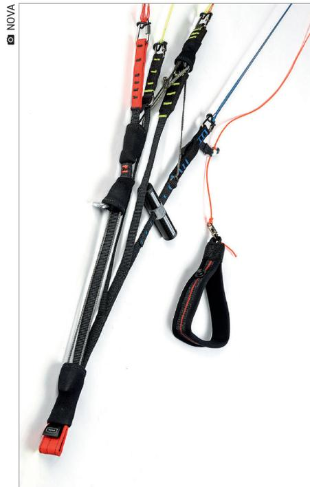
↑ Der Tragegurt des Mentor 7 ist auf die BC-Steuerung hin optimiert. Die hintere Leinenebene des Außenflügels sitzt auf dem Durchläufer zwischen A- und B-Gurt.
