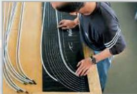
**Prüfung der Segellatten anhand des Segellattenplans.**
