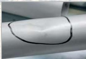
**Eine Beule am Flügelrohr lässt sich im eingebauten Zustand nur schwer erfühlen, wenn sie hinter der Mylar-Anströmkante liegt.**
