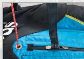
**Die Hauptaufhängung muss auf Scheuerstellen untersucht werden.**
