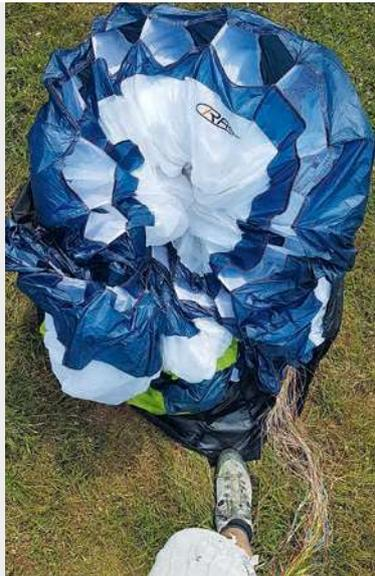
↑ Der Schnellpacksack liegt ca 70% geöffnet unter der Rosette und wird mit einem Fuss fixiert. Die Eintrittskante des Schirms bildet den äußeren Kreis. Jetzt wird die Mitte der Rosette kompakt in den Schnellpacksack gestopft. Dabei entweicht die Luft durch die offene Eintrittskante. Erst jetzt wird die Eintrittskante behutsam verstaut.
