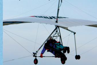
strukturer und Hersteller ist. Auf diesen Fahrwerken wurden zwischenzeitlich mehr als 3000 Starts und Landungen im doppelsitzigen Flugbetrieb nachgewiesen. Das Spornradfahrwerk wurde nach hinten zum Kielrohr und seitlich zu den Trapezecken verspannt. Dadurch werden die Torsionskräfte minimiert, die am Kielrohr auftreten. Als Gurtzeug wurde ein Etagegurt der Fa. Madreiter verwendet.
