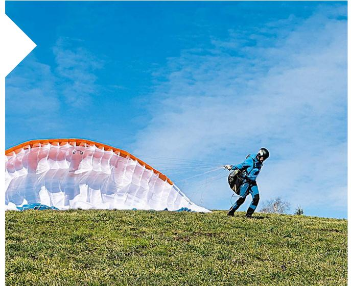
**ZUGPHASE:** Der Pilot macht ein bis zwei entschlossene Schritte, um der Kappe den nötigen Anfangsimpuls zu geben. Je weniger Wind desto mehr Anfangsimpuls. Der Zug wird über die Karabiner ausgeübt, die Hände begleiten den A-Gurt nach oben und unterstützen bei Bedarf durch leichtes Heben das Steigen der Kappe.
