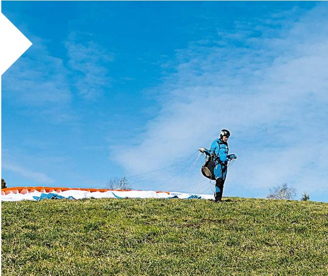
**GRUNDHALTUNG:** Der Pilot steht mittig vor der bogenförmig vorge-spannten Kappe. Die A-Leinen hängen symmetrisch ganz leicht durch. Die Unterarme sind fast waagrecht; die Oberarme sind und bleiben nah am Körper. Die A-Gurte liegen auf den nach oben gedrehten Handflächen. Die Hände umfassen die jeweiligen A-Gurte locker ca. 10 cm unterhalb des Leinenschlosses (kurzer Griff).
