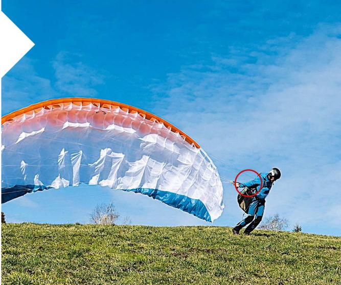
**ÜBERGANG ZUGPHASE – STEIGPHASE:** Sobald der Pilot deutlichen Zug spürt, reduziert er seine Vorwärtsbewegung und wartet auf den steigenden Schirm. Die Unterarme mit den Händen begleiten die A-Gurte. Die Drehachse ist der Ellbogen (nicht die Schulter) in der Nähe der Karabiner. Die Oberarme bleiben locker am Körper.
