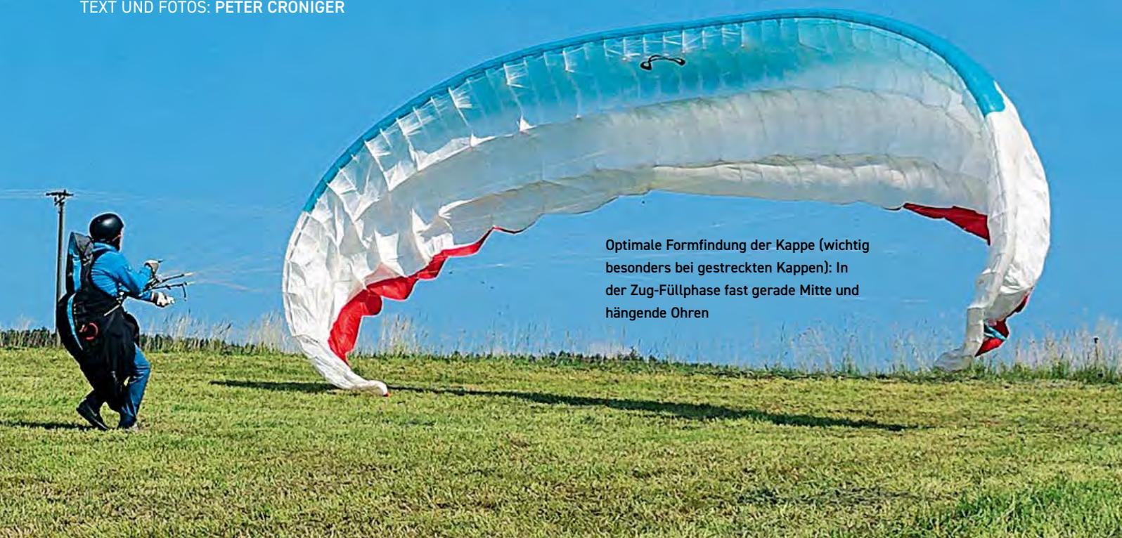
Optimale Formfindung der Kappe (wichtig besonders bei gestreckten Kappen): In der Zug-Füllphase fast gerade Mitte und hängende Ohren
