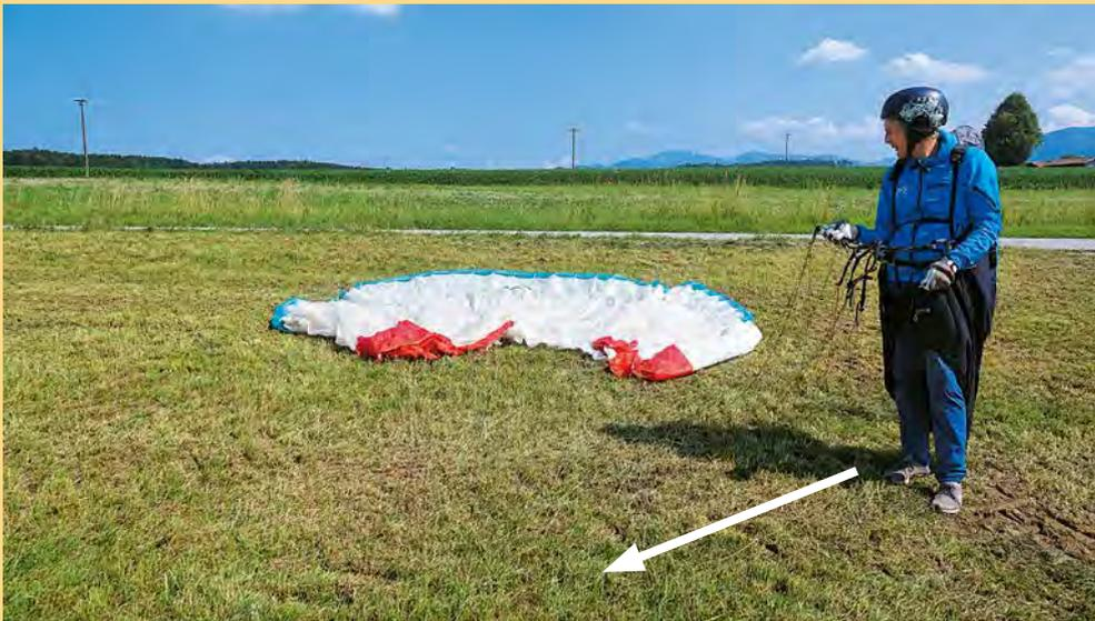
Beide inneren A-Gurte sind in einer Hand. Der Pilot bewegt sich vor dem Beginn des Aufziehens mehr zur Mitte und/oder läuft frontal schräg vorwärts (hier Richtung Bildmitte), damit die linke Schirmseite der freien linken Hand zuerst auf Zug kommt. Er kann dies durch seitliches Verschieben der Tragegurthand verstärken oder abschwächen.
