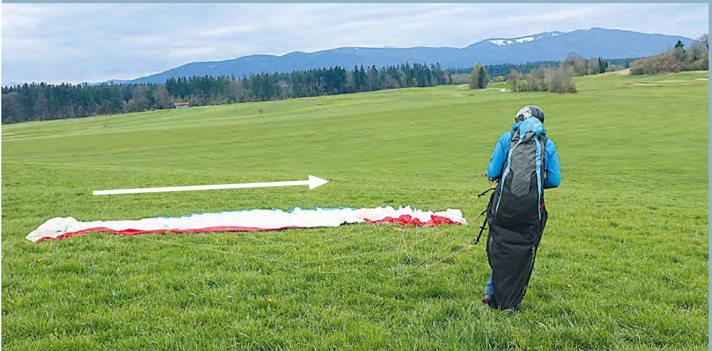
Einfaches gerades Auslegen des oberen Flügels parallel zur Anlaufstrecke/bzw. Wind, der untere Flügel kann gerafft bleiben, die Leinen liegen frei. Aufstellen der Eintrittskante ist bei dieser Technik nicht erforderlich.
