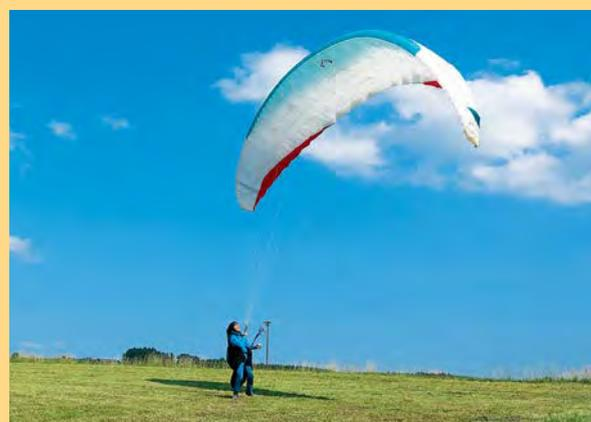
Kurz vor dem Zenit der Kappe ist die Blickkontrolle abgeschlossen. Der Pilot dreht sich weiter frontal aus und übernimmt jetzt die Überfahrt des Schirms durch schnelles Mitgehen in Startrichtung. Damit ist der Schirm ohne Abbremsen stabilisiert und hat Tempo und Stabilität bei guter Richtungskontrolle.
