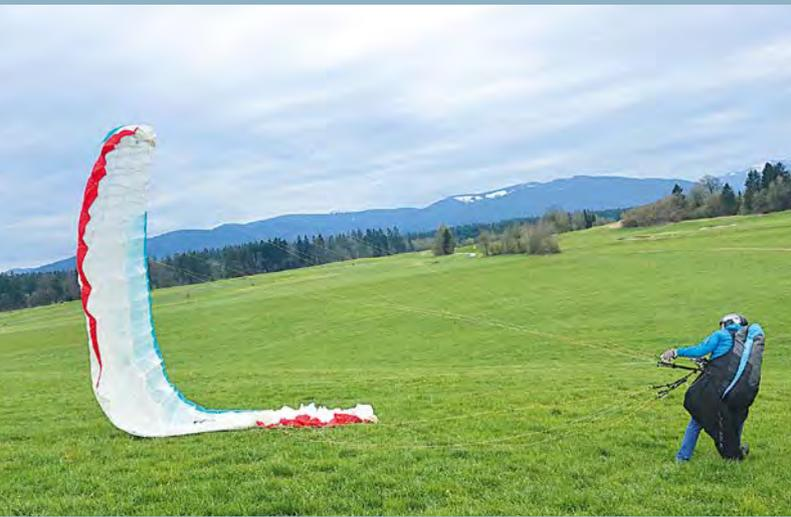
Die rechte Bremse darf nur wenig und gefühlvoll gezogen werden. Während des „Hochkippens“ kann die Kappe gut visuell kontrolliert werden, wenn sie sich nach und nach vom Boden löst.
