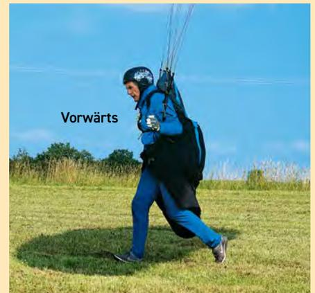
Der Anstellwinkel ist stabil und die Steuerleinenstellung gut für eine kontrollierte aktive Beschleunigungsphase. Das Tempo der Kappe wurde vom Piloten mitgenommen. Der Startlauf kann homogen beginnen.
