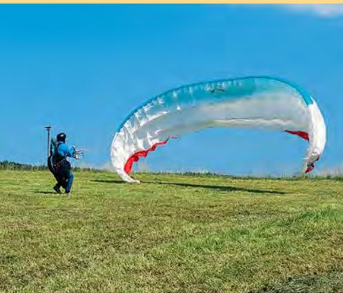
Über Zug auf der freien Bremse streckt sich die Kappe gekrümmt und bildet für die Steigphase ein in der Mitte effektiv gewölbtes Profil aus. Besonders bei hoch gestreckten Kappen müssen sich die „Ohren“ verspätet füllen, um einen Knick und Eindellen der Eintrittskante zu vermeiden. Das geraffte Auslegen (Fächer oder Rosette) fördert dies, bedingt aber einen größeren Anfangsimpuls.
