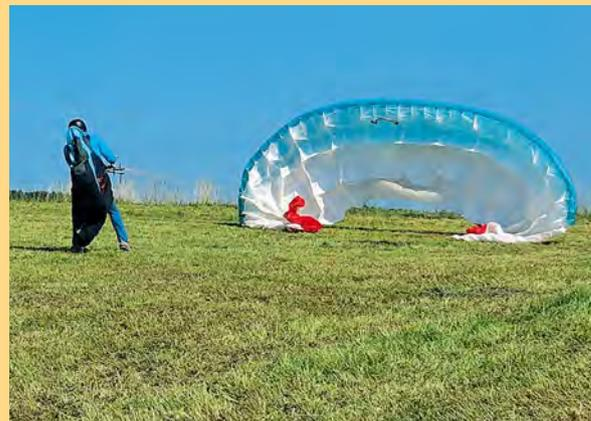
Der Schirm wird durch die relativ gerade Mitte symmetrisch gefüllt und richtig geformt. Die Blickkontrolle beginnt. Der Pilot beobachtet im Stehen genau die Abschnitte der Kappe, die sich vom Boden lösen auf etwaige ungewollte Verformung oder Verhänger.
