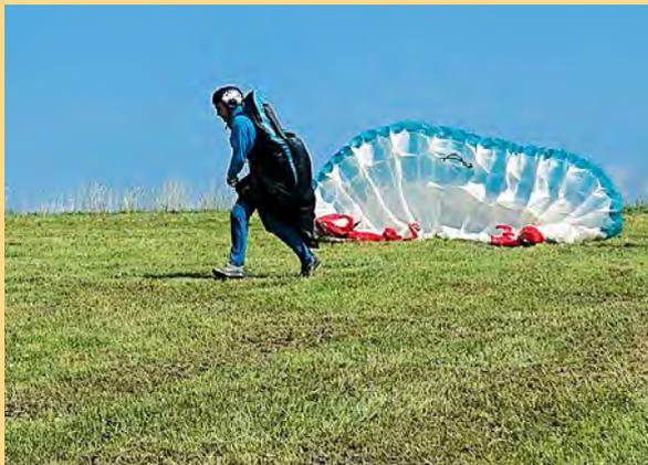
Der Pilot läuft vorwärts. Bei Zug auf den A-Leinen und zu Beginn des Füllvorganges dreht sich der Pilot zur Kappe, verstärkt hier den Zug der schlechter steigenden Seite. Das dynamische Steigen und Formen auf einer Kreisbahn beginnt. Der Pilot lässt sich vom füllenden Schirm bremsen, verzögert stark, hält aber deutlichen Zug auf den Leinen.
