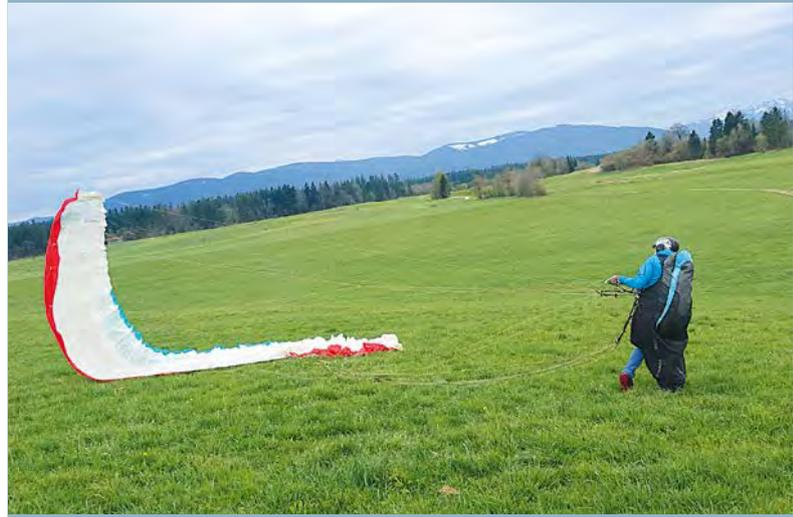
Der Pilot läuft nach vorne in Startrichtung. Er hat die rechten A-Gurte anfangs kurz in der linken Hand und eine freie rechte Bremse.
