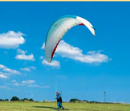
Richtung und Anstellwinkel der Kappe passen, der Blick geht in Startrichtung. Startentscheidung: Der Pilot wird durch Anklicken mehr Vorlage einnehmen und mit leichtem Lösen der Bremsen in die Lauftechnik wechseln, um optimal zu beschleunigen; oder durch Überbremsen den Abbruch einleiten.
