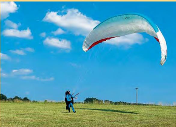
Der Pilot kann mit der „Tragegurt-Hand“ bei Bedarf einen hebenden Kick geben und dann die Gurte früh auslassen; die Hüfte übernimmt. Damit erhält er auch über die zweite Bremse eine gute Kontrolle über den ganzen Schirm. Der Pilot ist immer noch fast „ortsfest“; er wartet auf die steigende Kappe und verbraucht keine Startstrecke.
