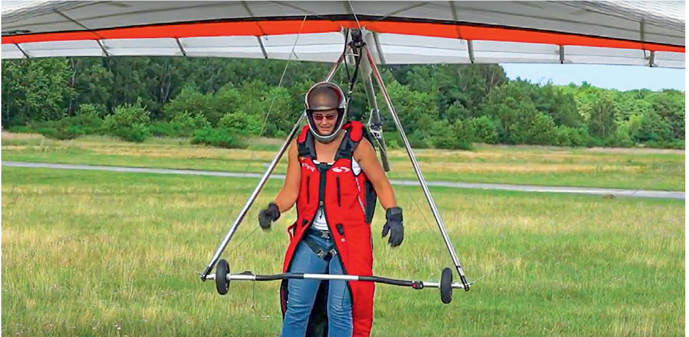
Ausschnitt aus einem Schulungsvideo: Auf diesem Bild fliegt der Drachen ohne Zutun des Piloten mit dem richtigen Anstellwinkel. Deshalb: Groundhandling ist wichtig, um ein Gefühl für das Fluggerät zu entwickeln! Ines Ziessau zeigt im Schulungsvideo Tipps und Tricks beim Groundhandling auf youtube.
