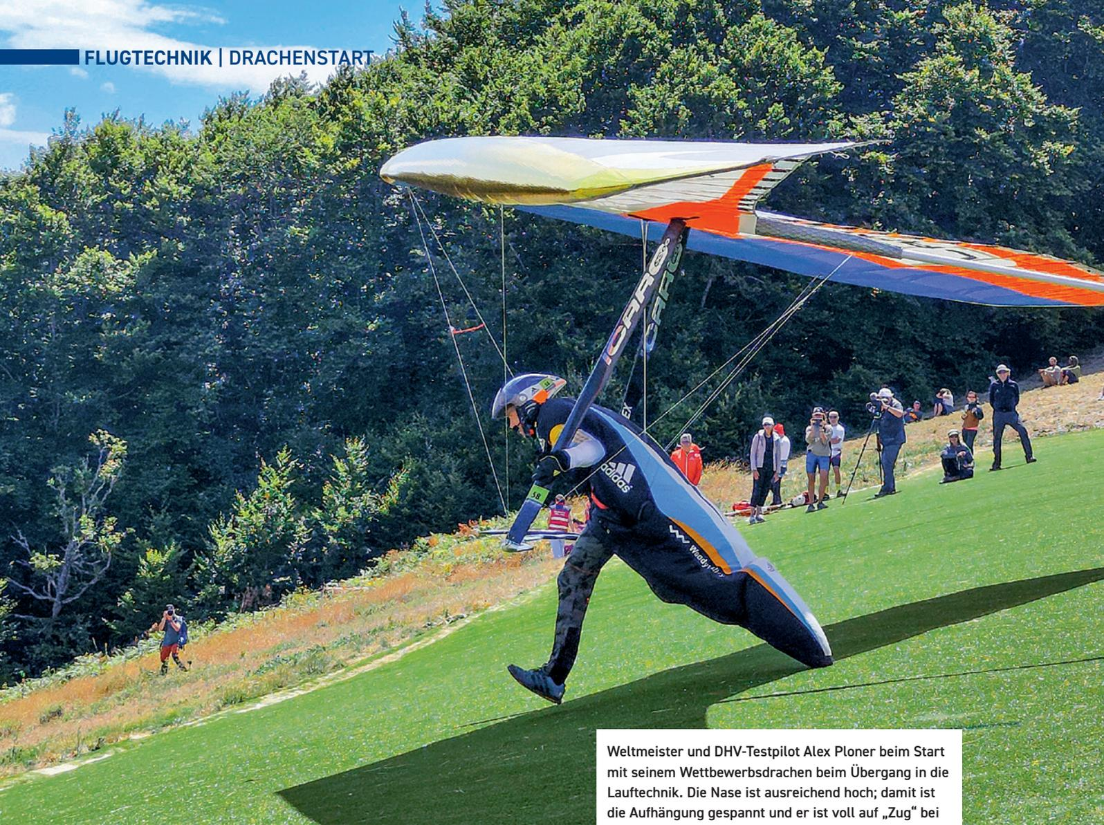
Weltmeister und DHV-Testpilot Alex Ploner beim Start mit seinem Wettbewerbsdrachen beim Übergang in die Lauftechnik. Die Nase ist ausreichend hoch; damit ist die Aufhängung gespannt und er ist voll auf „Zug“ bei absolut lotrechter Aufhängung. Dadurch erhält er mit hoher Flächenbelastung eine gute Beschleunigung bei erstklassiger Kontrolle durch die Effektivität der Gewichtskraftsteuerung.
