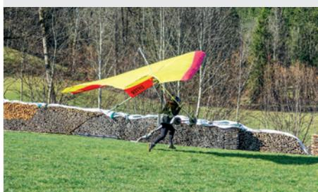
Bei korrekter Grundhaltung ist die Basis fast in Kniehöhe. Das Ausrichten um die Querachse ist letztlich nicht alleine bestimmend. Bei ausreichend hoher Nase wird sich die Aufhängung früh spannen und die Nickstabilität des Drachen hilft der Pilotin, den korrekten Trimmanstellwinkel einzunehmen. Steter Zug am Steuerbügel kompensiert die Hecklastigkeit des Drachen.
