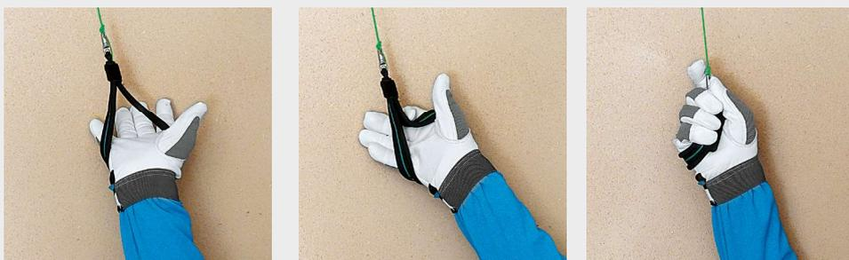
↑ Mit dem Handrücken nach unten wird eine Griffseite ohne Dreh- und Wickelbewegung umgeschlagen. So ergibt sich eine kompakte und gefühlvolle Kraftübertragung.
