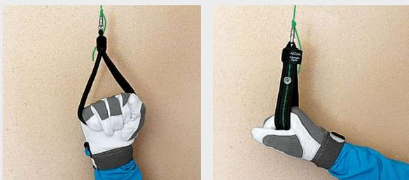
← Die Handfläche umschließt den Steg im Kraftgriff. Erschwert das Spüren des Steuerdrucks und verleitet zum gefährlichen Abstütz-Reflex. Für manche Manöver, die lange Steuerwege benötigen, ist dieser Griff kurzzeitig einzusetzen.
