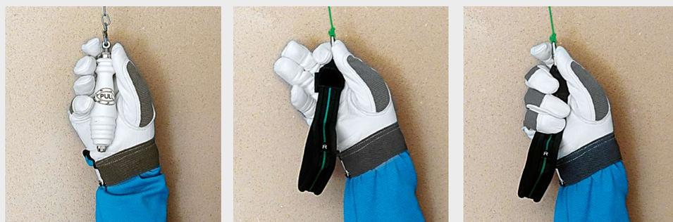
↑ Gefühlvoller Zug-Griff bzw. Präzisionsgriff. In seiner Urform durch die konische Form und bei optimaler Höhe gut und gefühlvoll zu greifen. Als Hinweis sogar beschriftet, um zu erinnern, dass an einer Leine gezogen und nicht gedrückt, gezerrt, oder abgestützt wird.
