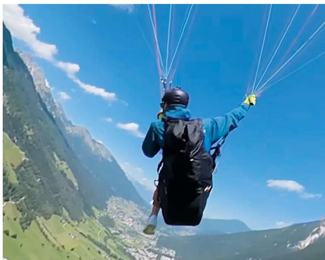
← Die Griffhaltung beeinflusst die Steuerleinenführung. Beim Ziehen bleibt der Ellbogen am Körper, der Zug geht direkt am Tragegurt entlang (ohne Umlenkung an der Steueröse). Die Griffhaltung erleichtert auch ein schnelles Einnehmen der Nullstellung mit der Außenhand.
