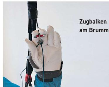
↑ Einige Hersteller beschäftigen sich intensiv mit dem Thema Trimmung und bieten für Bergschirme leicht zu montierende Feststell-Trimmer für den vorderen A-Gurt (Extra-Zubehör), um auch ohne Fußbügel eine Verstellung des Trimmings zu ermöglichen. Sie verbinden den Flaschenzug des A-Gurts mit dem Karabiner und ermöglichen eine Beschleunigung auch mit Steigeisen oder Schi an den Füßen.
